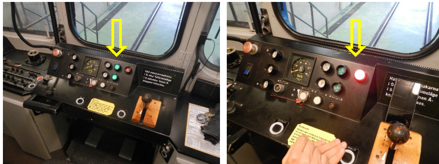
Figur 8. Bilder från en C14 förarhytt. Till vänster lyser båda indikeringslamporna "klart" för klarsignalen och till höger har de slocknat och i stället har kontrasignalen för "stopp" tänts.
