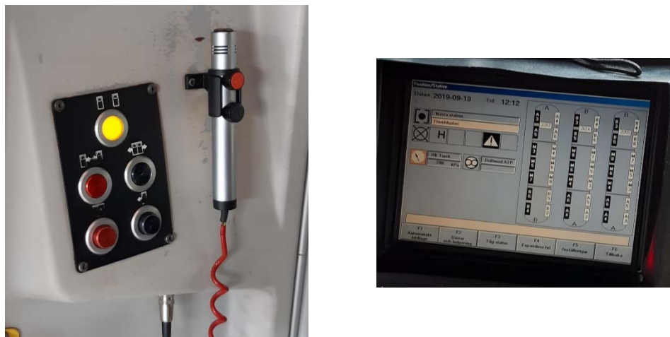
Figur 11. Invändig indikeringslampa och i den digitala displayen visas vilket dörrpar som avses i C20-vagn. Foto: MTR Tunnelbanan AB.
