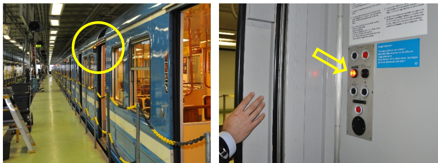
Figur 9. På vänster bild syns den utvändiga gula sidosignalen på en C14/C15-vagn. Till höger syns motsvarande indikering på dörrmanövreringspanelen innanför förarhyttens dörr.
