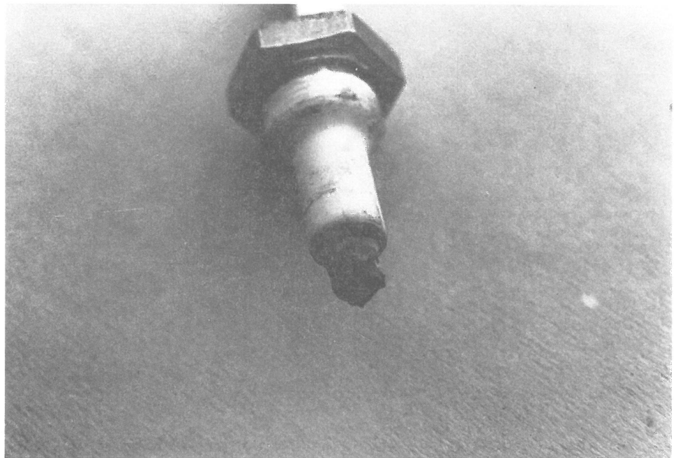
TÄNDSTIFT. Nedsmält mittelelektrod. I smältan finns även aluminium från kolvtopp
