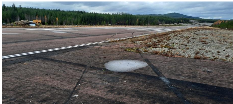
Figur 5. Spår av däck på banan. Avståndet mellan däckspåren mättes till 2,20 meter. Foto: Privatperson.
