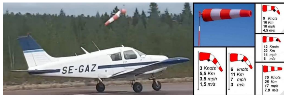
Figur 3. Vindstruten vid en tidigare landning på samma bana och principen för en vindstrut. Foto: Privatperson.
