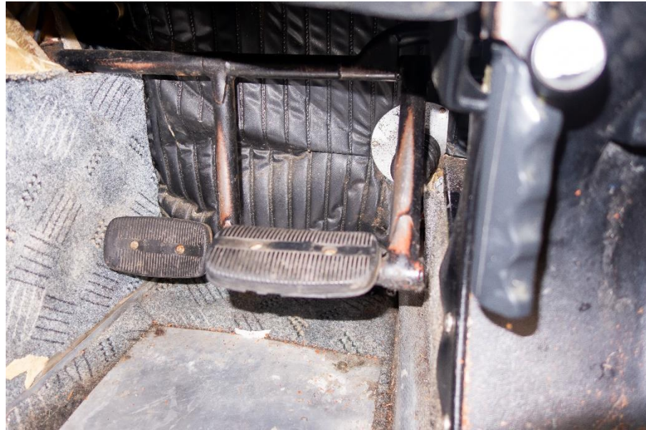
Figur 2. Pedalerna som styr noshjulet och sidrodret här med vänster pedal intrampad. Till höger syns bromshantaget.
