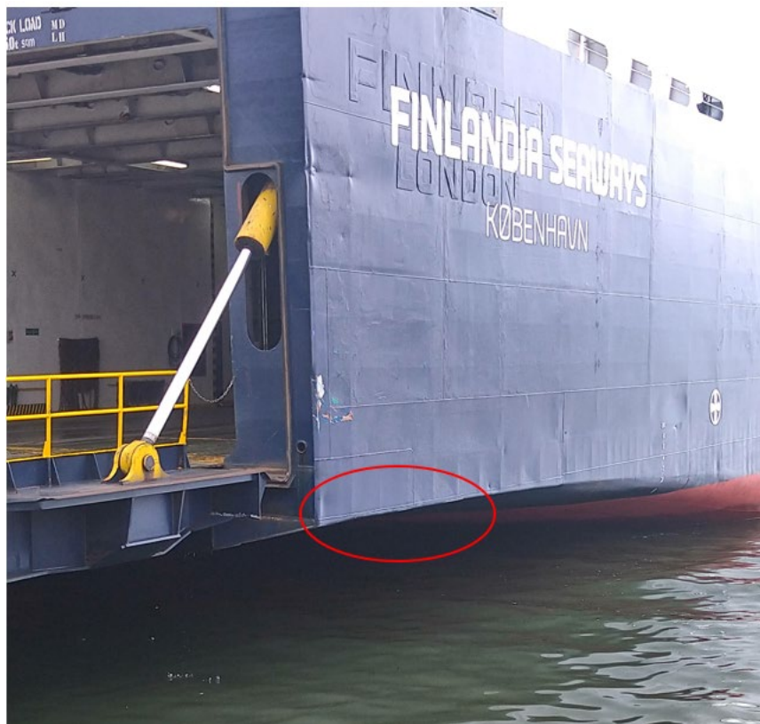
Figur 5: Bild på FINLANDIA SEAWAYS styrbords akter. I inringat område uppstod skrapmärken.
