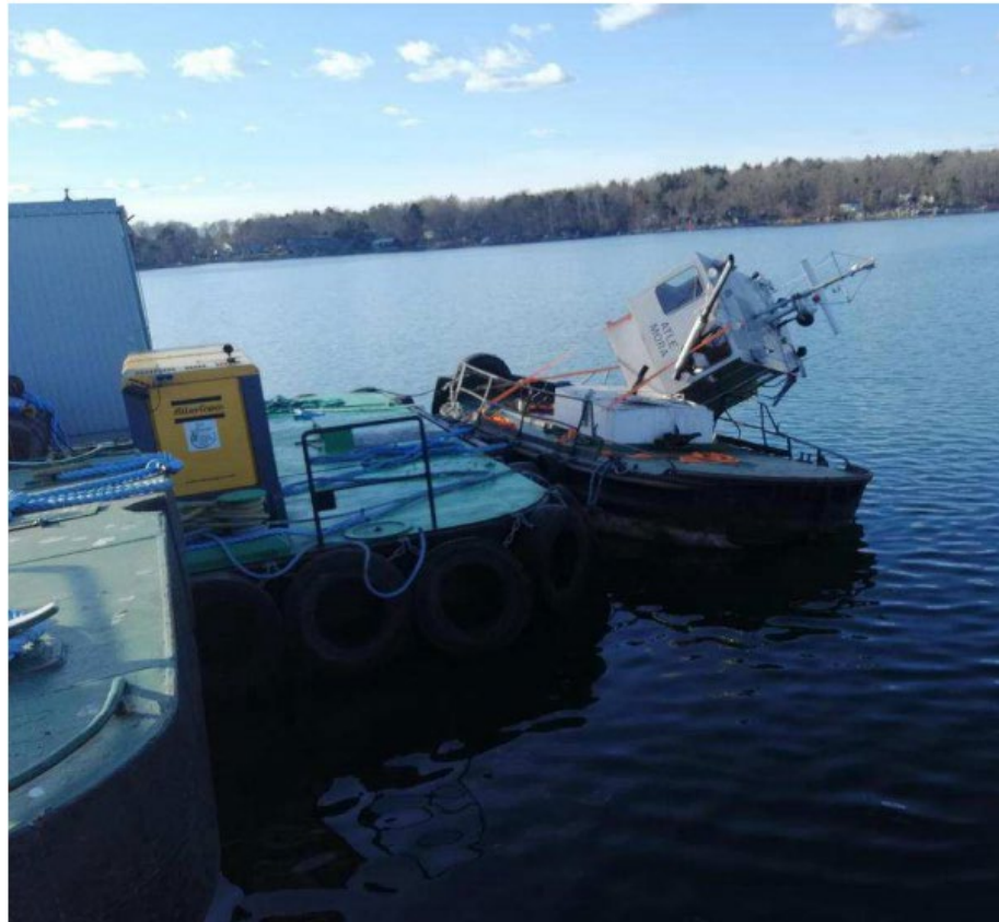
Figur 6: Bild på bogserbåten ATLE med avslitet styrhus. Mudderverkspråmen LENNART till vänster i bild. Bild: Kustbevakningen (bilden är redigerad av SHK).
