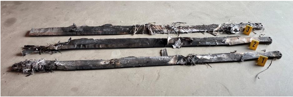
Figur 28: De tre hovedrotorbladene. Bladtuppene til venstre i bildet. Foto: SHK
