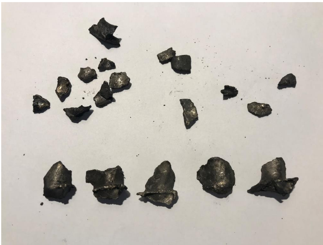
Figur 60: Turbinbladfragmenter funnet under demontering av motoren. Foto: SHK
