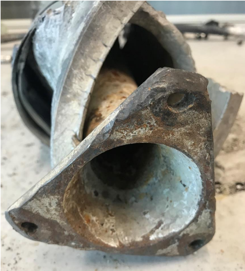
Figur 49: Drivaksel mellom motor og hovedgirboks med flens for kobling mot girboks. Flens har flere rotasjonsskader og ingen rester fra den fleksible koblingen. I bakgrunnen vises en sterkt varmeskadd gimalkobling som også viser tegn til rotasjonsskader. Foto: SHK
