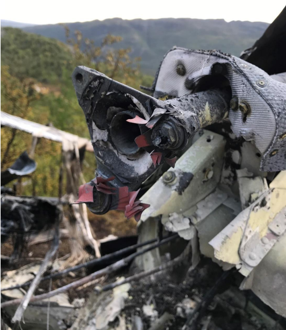
Figur 29: Bruddet i drivakselen til halerotoren mellom skroget og halebommen med typisk brudd i den fleksible koblingen. Foto: SHK
