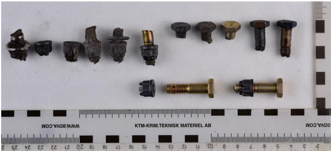
Figur 50: Alle bolthalvdelenene som ble funnet. Nederst i bildet er to hele bolter med muttere vist som referanse. Ved montering vil mutteren være sikret til bolten med en låsepinne som føres gjennom hullet i enden av bolten. Foto: DNV GL/SHK
