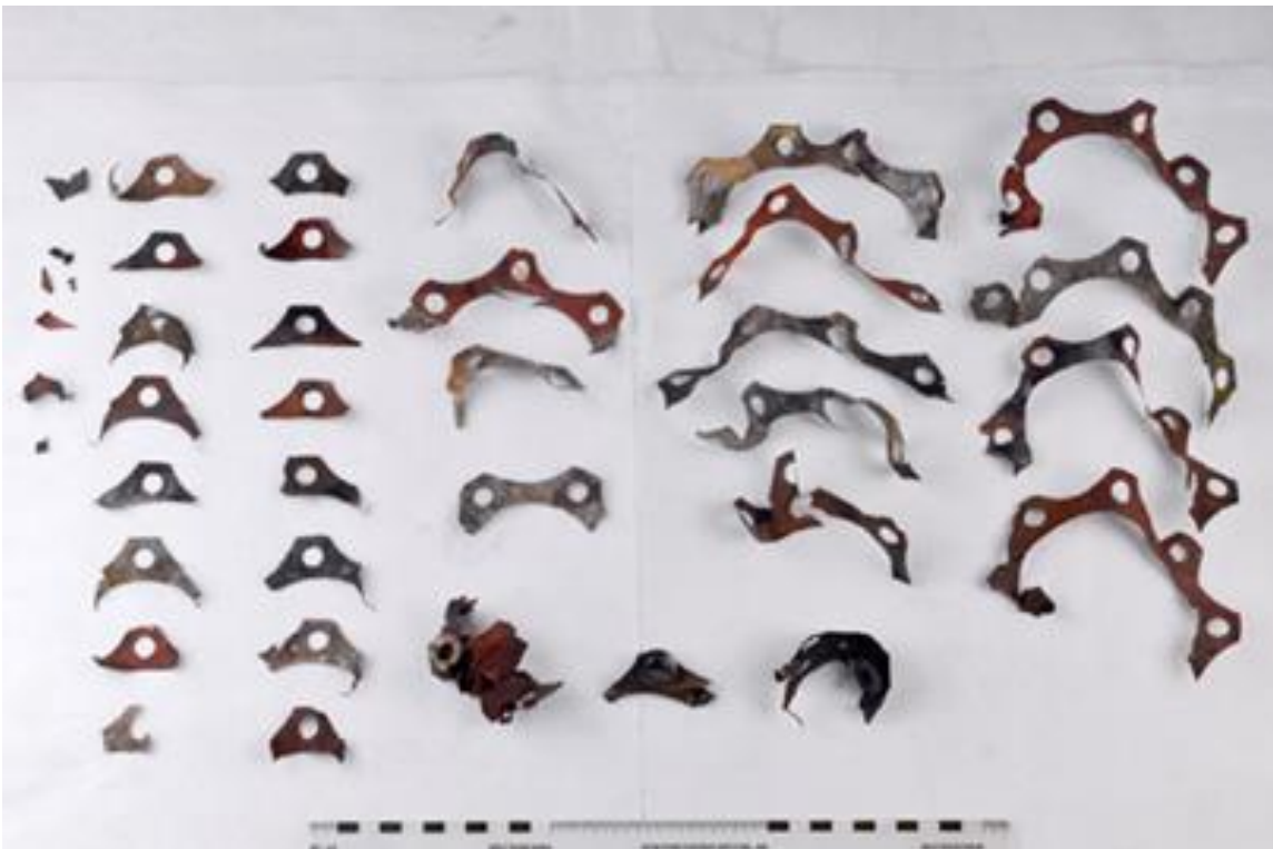
Figur 53: Lamellsegmenter fra den fleksible koblingen. Foto: DNV GL/SHK
