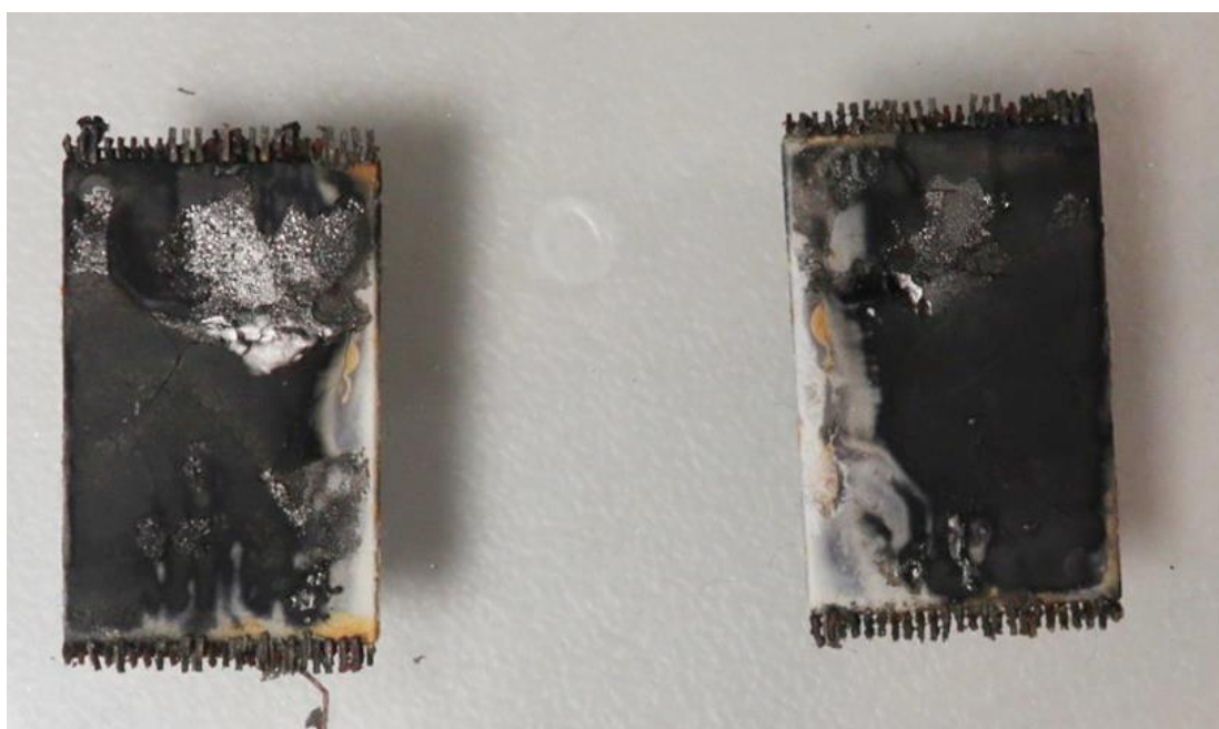
Figur 22: Minneenhetene fra Apparéo-enheten som ble undersøkt av Thales. Foto: BEA
