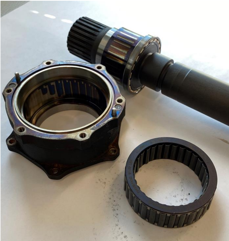
Figur 66: Frihjulskoblingen. Fra venstre mot høyre: ytterringen med blå oksideringsmerker, den indre akslingen med oksideringsmerker etter låseelementene (sprags) og ringen med låseelementer nede til høyre. Foto: SHK
