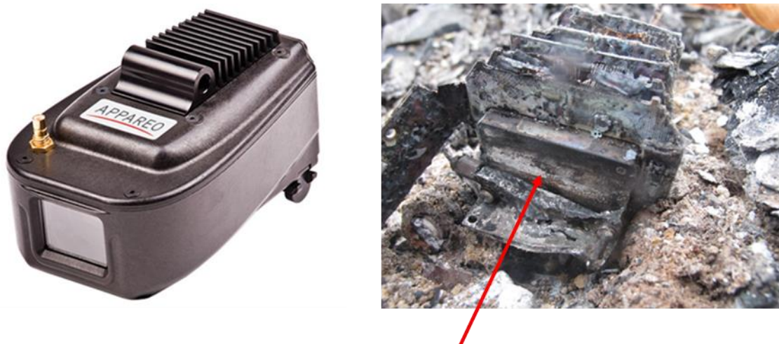
Figur 21: Apparéo Vision 1000 i uskadet tilstand, og den sterkt brannskadde som ble funnet i LN-OFU. Pilen peker på innkapslingen rundt den faste minnemodulen. Kilde: Apparéo Systems, LLC og Airbus Helicopters
