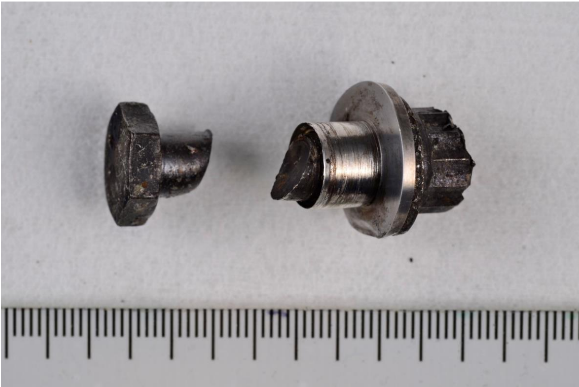
Figur 51: Bruddet i en av boltene. Hylsen som går gjennom lamellene er til høyre ved mutteren. Foto: DNV GL/SHK
