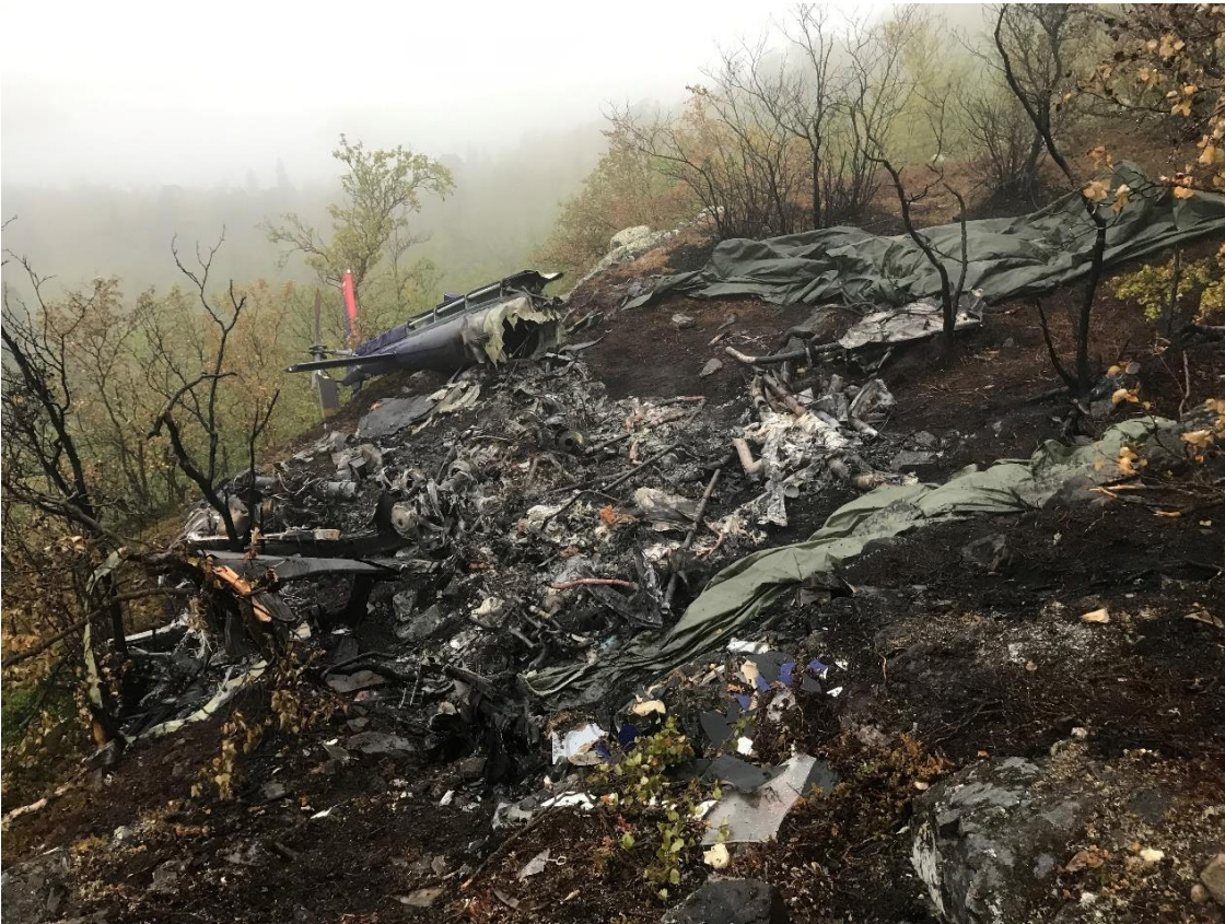
Figur 25: Havaristedet ved Skoddevarre sett fra østlig retning, med fronten av helikopteret nærmest i bildet. Buskene helt til høyre i bildekanten var ikke skadet av hovedrotoren. Presenningene er lagt ut for å beskytte vrakrestene. Bildet er tatt etter at de omkomne er hentet ut. Foto: SHK
