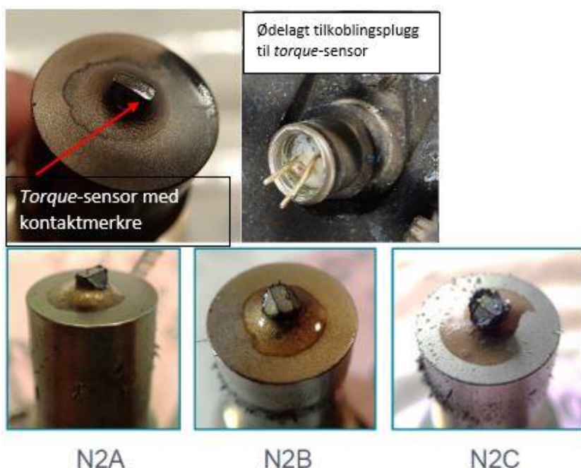
Figur 64: Torque-sensoren med kontaktmerke på pickup, den ødelagte tilkoblingspluggen til torque-sensoren og de tre N2 sensorene uten skade. Foto: Safran Helicopter Engines/SHK
