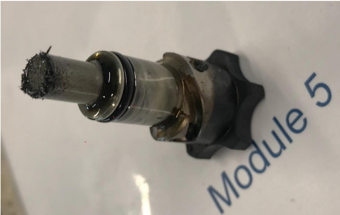
Figur 57: Magnetplugg for olje i Module M05. Foto: SHK
