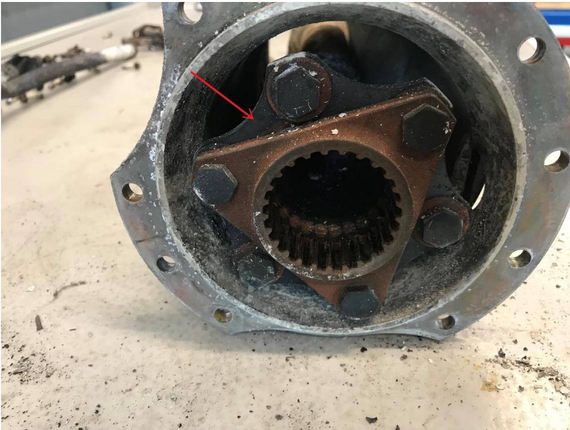
Figur 48: Motorsiden av drivaksel mellom motor og hovedgirboks. Den fleksible koblingen (se rød pil) framstår som nesten uskadd. Foto: SHK
