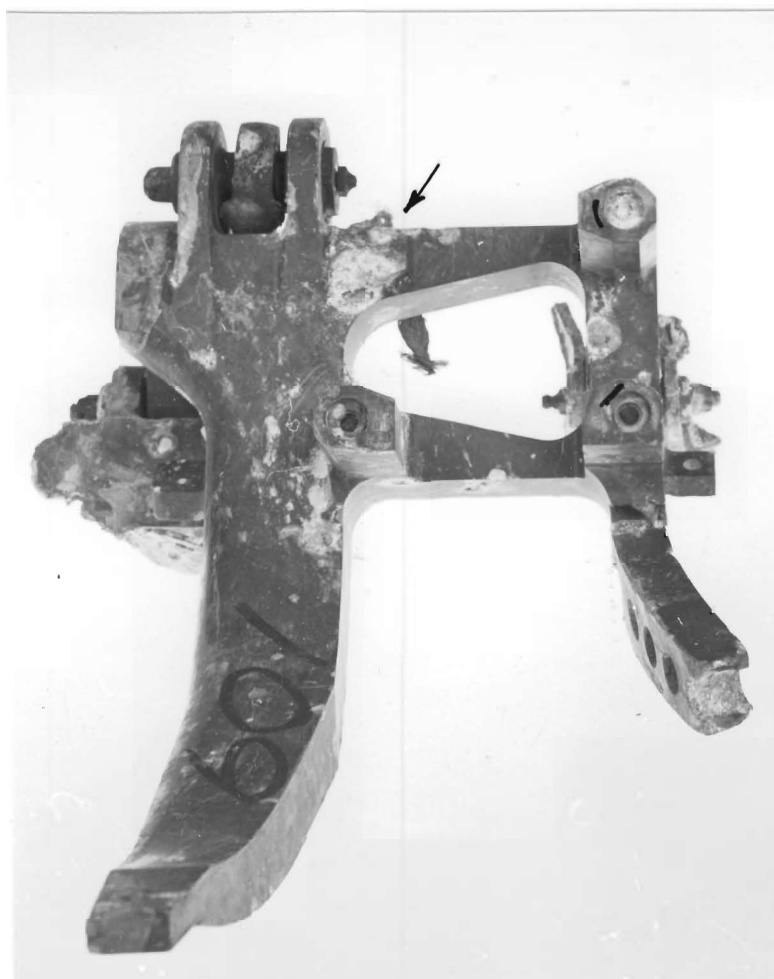
Fig 1 (Neg nr 26499) Stativ till reservelaggregat fpl 37.092. Pilen markerar brottriktning för generatorns ena stödben. Deformationer vid bakre stöd- benens hål är markerade.
