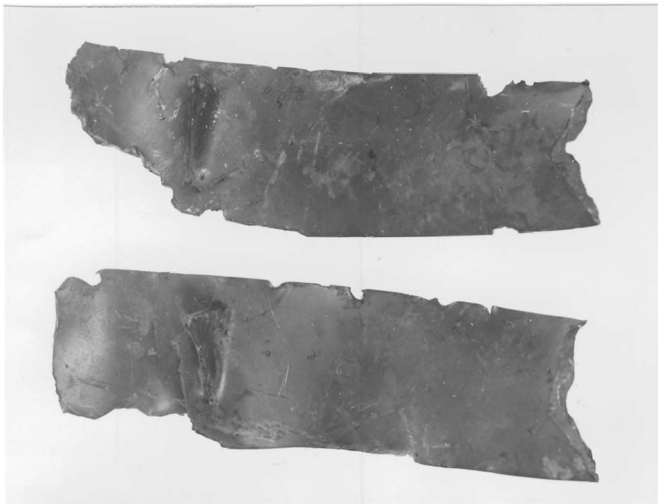
Fig 9 (Neg nr 26487) Kompressorskovlar steg 2, konvex sida.
