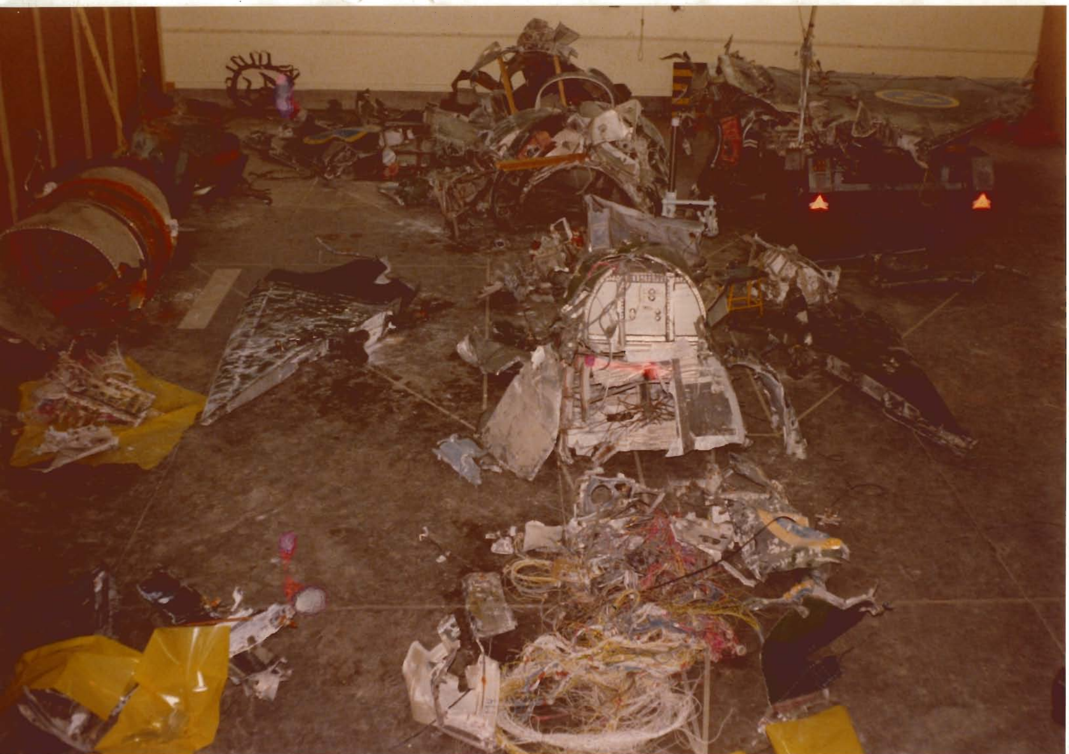
Foto 1 översiktsfoto över bärgade flygplanrester utlagda flygplanorienterat i hangar.
