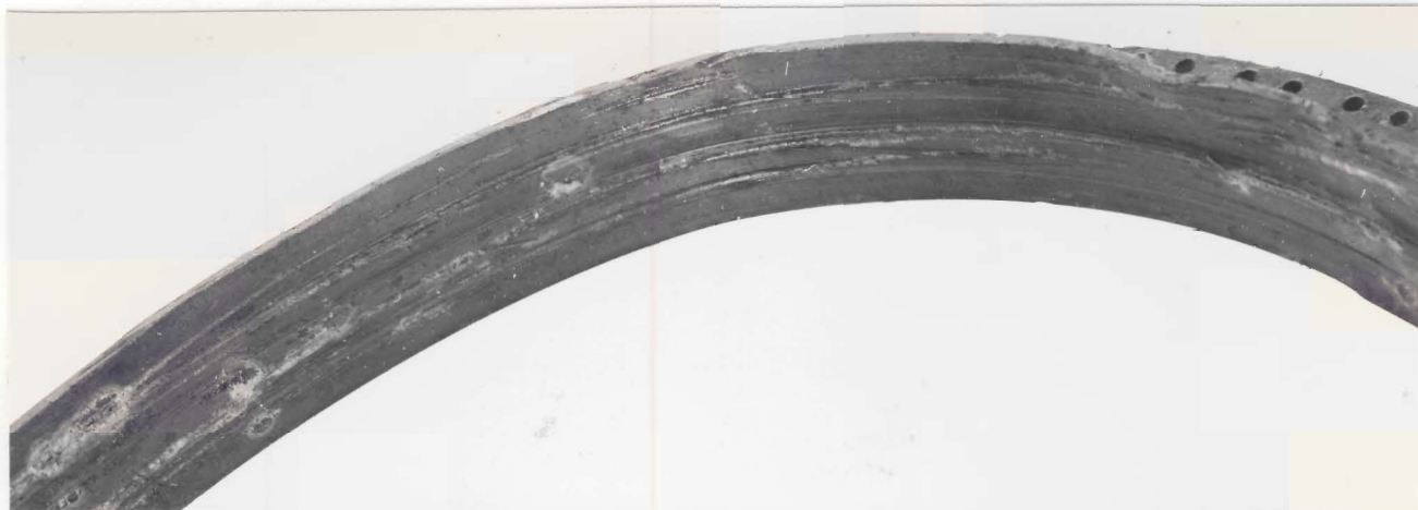
Fig 11 (Neg nr 26473) Detaljbild av lufttättningsring 1 där man ser spår från tätflänsarna från kompressorring 1-2.
