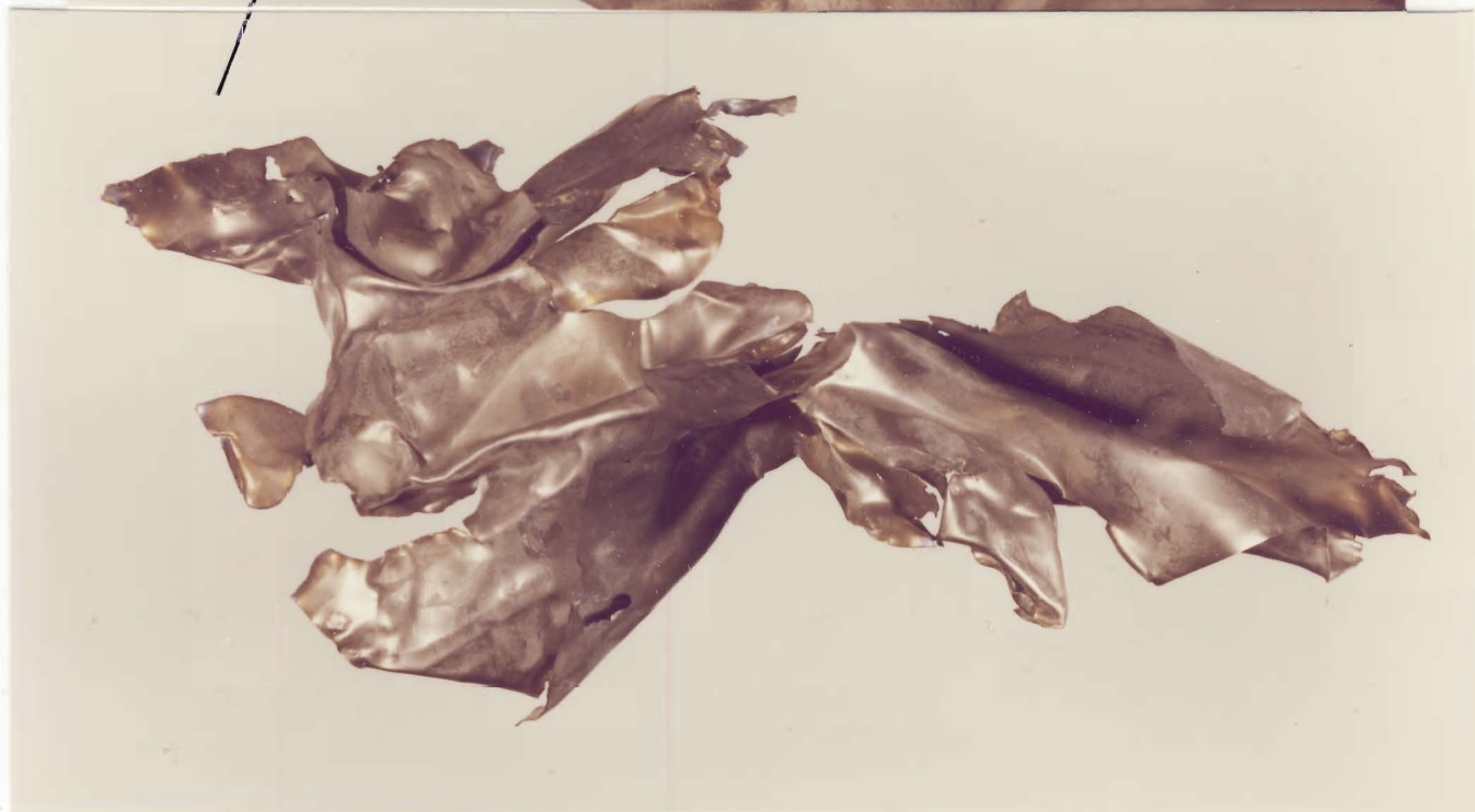
Fig 12 (Neg nr 26770 och 26771) Titanplåt från strålningskydd. Ovanför syns en detalj av värmepåverkat område.
