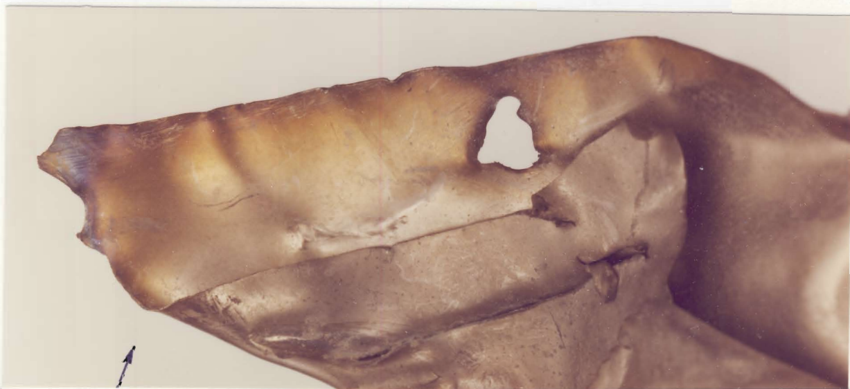
Fig 11 (Neg nr 26473) Detaljbild av lufttättningsring 1 där man ser spår från tätflänsarna från kompressorring 1-2.
