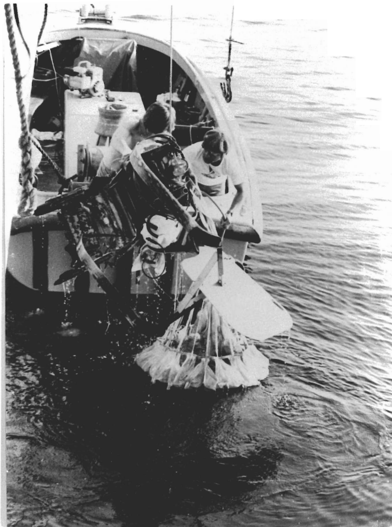
Bärgning av förarstolen med stabiliseringskärm, vilken har fastnat i undervattenkamerans stativ.
