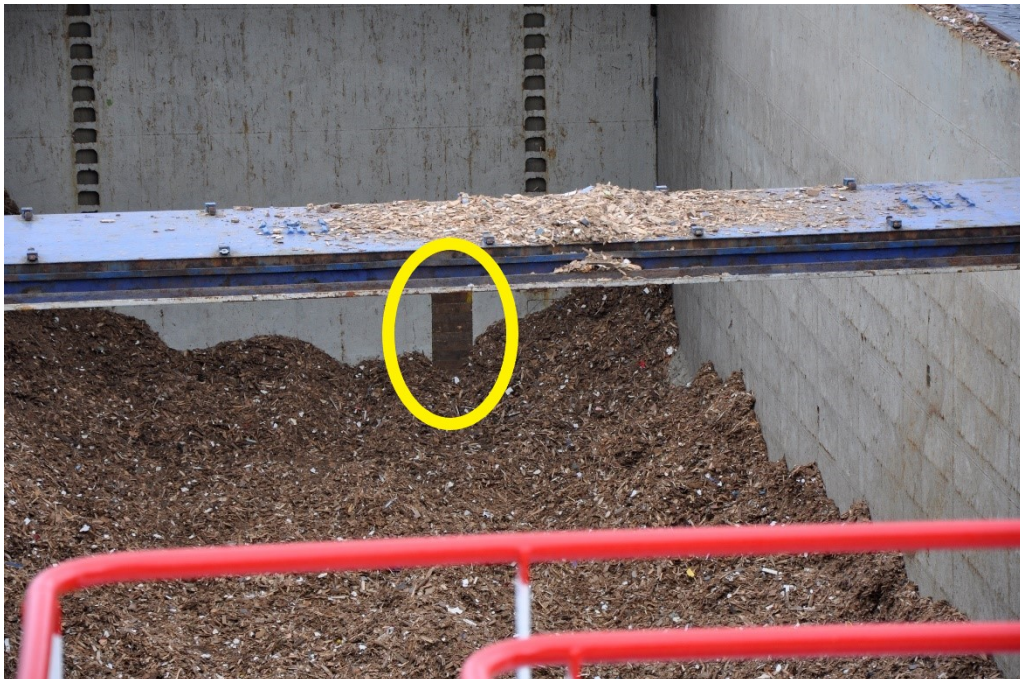
Fig. 3. Bilden, som är riktad förut från akterkant av lastrummet, visar lastrummet efter att en stor del av lasten lossats. I mitten av bilden syns utgången (markerad med gult) från den förliga nedgången ut till lastrummet. Trävirket som ska hindra lasten från att hamna i nedgången är fortfarande monterat i spåren i dörrhålet. Insidan av dörrhålet ses i fig. 4.
