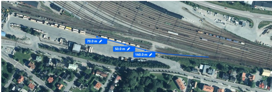
Figur 17 visar ett utdrag från kartor på Eniro med en blå linje från den motriktade dvärgsignalen 241 till höger, en markering vid 160 m, en efter ytterligare 50 meter samt en med 70 meter fram till platsen där första vagnen stannade. Bild från Eniro.se, https://kartor.eniro.se/?c=62.385404,17.317307&z=17&l=aerial&q=%22sundsvall%22;geo , © Lantmäteriet Dnr R61749 190001. Markeringarna är tillförda av SHK.
