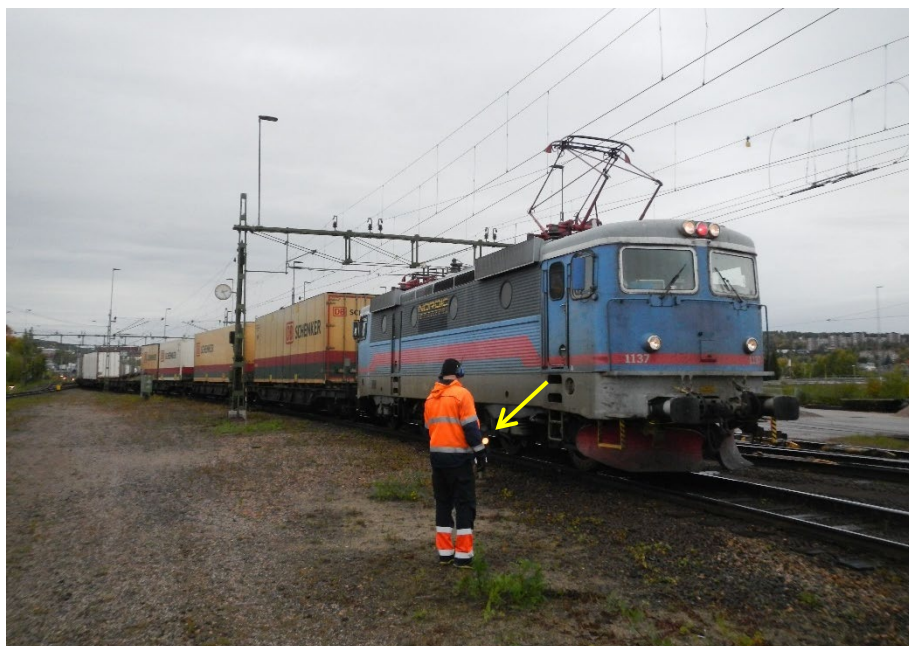
Figur 14. Rc4-loket i samband med växling in till kombiterminalen under SHK:s platsbesök den 25 september 2020. Dvärgsignal 130, delvis skydd bakom signalgivaren, är markerad med en gul pil.
