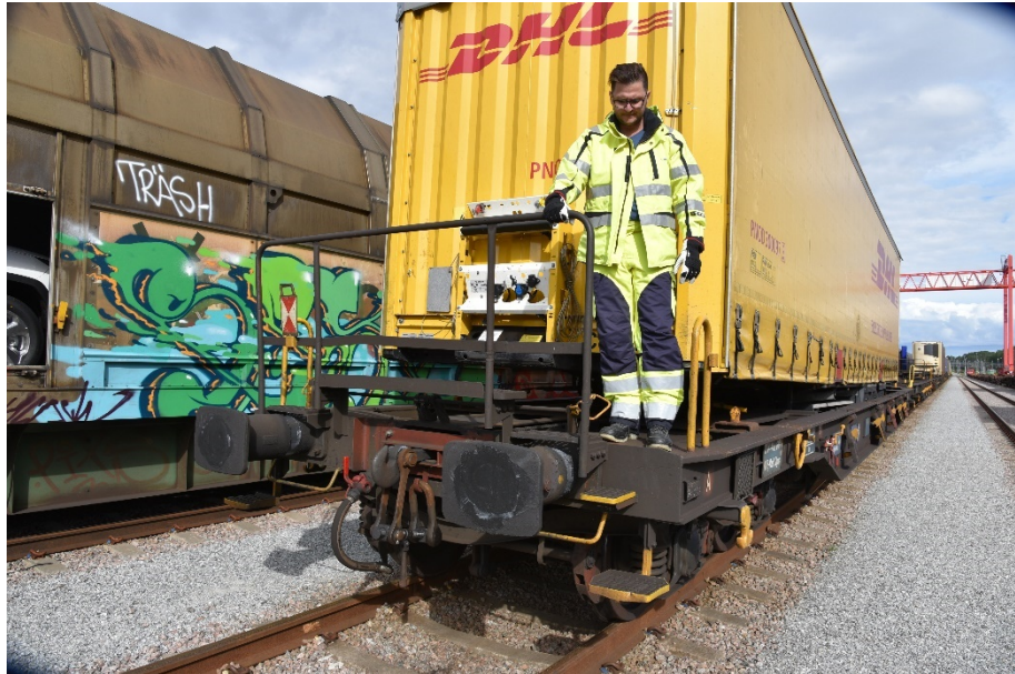
Figur 5. Bild från SHK:s besök i Rosersberg med en person placerad till höger om räcket varifrån signalgivaren sannolikt föll från vagnen. Notera att personen på bilden är 20 kortare än signalgivaren.
