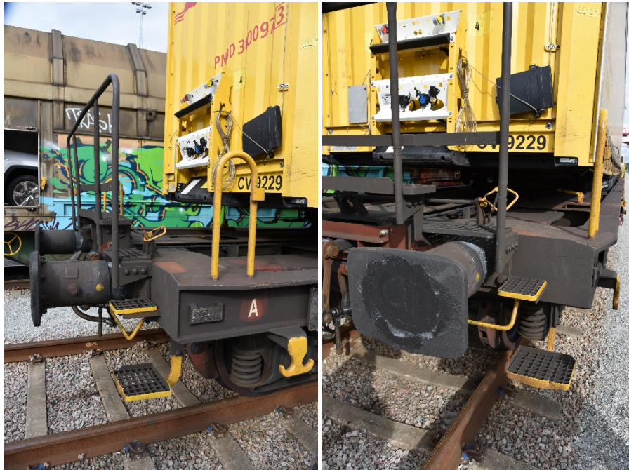
Figur 20 visar i två perspektiv fotsteg, plattform och räcke på den aktuella vagnens A-ände.
