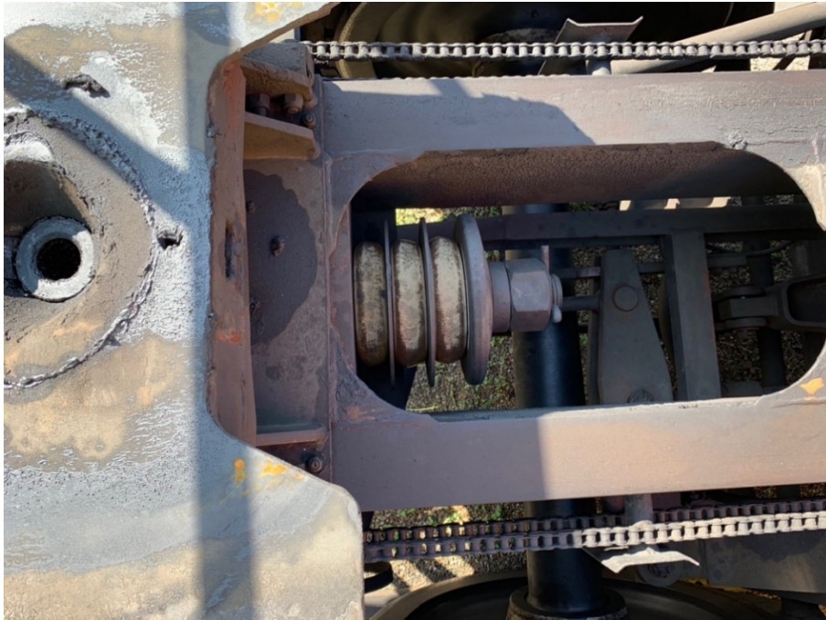
Figur 31. Koppelfjädring av typen Teks-pak på en Sdgms 832 -vagn. Bild från Rail-X dokument UI02-03 Underhållsinstruktion för vagnar littera Sdgms 832 .
