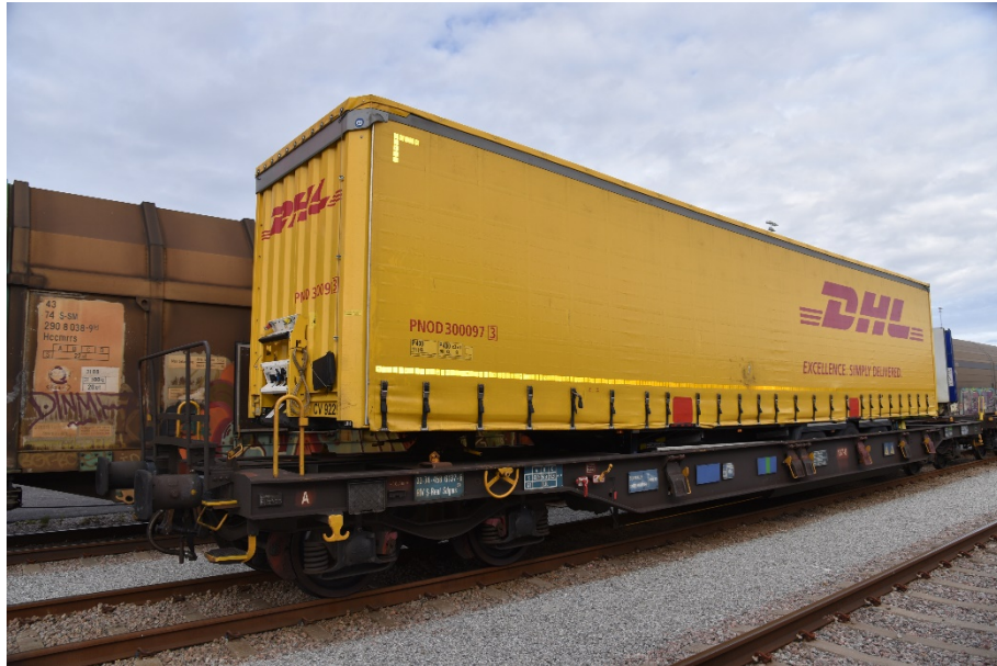
Figur 13. Sdgms 832 3374 4586 137-6 som signalgivaren åkte på, lastad med en motsvarande DHL-trailer som vid olyckstillfället. Fotograferad av SHK i Rosersberg den 28 augusti 2020.
