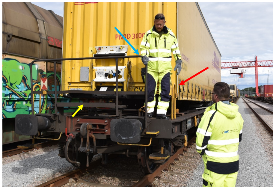
Figur 28 visar en man av medellängd stående på vagnens A-ände i förhållande till både räckverket (markerat med blå pil) och till det lägre gula bygelhandtaget, placerat under personens vänstra arm (röd pil). Den gula pilen visar kanten framför plattformens galler.
