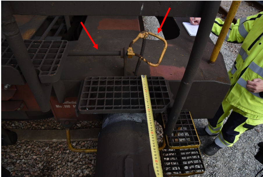
Figur 29 visar de lägre delarna av plattformen med det högre partiet till vänster samt stängen och handtaget för frigöring av kingpin-lådan direkt bakom gallret (röda pilar). Foto från SHK:s platsbesök i Rosersberg den 28 augusti 2020.
