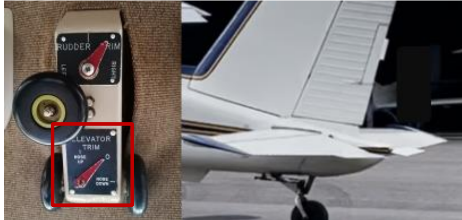
Figur 19. Den vänstra delen av bilden visar en triminställning som, enligt andra piloter, är normal för start med en pilot och åtta hoppare ombord. Röd ruta visar höjdrodertrimmen. Den högra delen visar trimrodrets position före en av de tidigare flygningarna under dagen. Bild: Örebro Fallskårsklubb.
