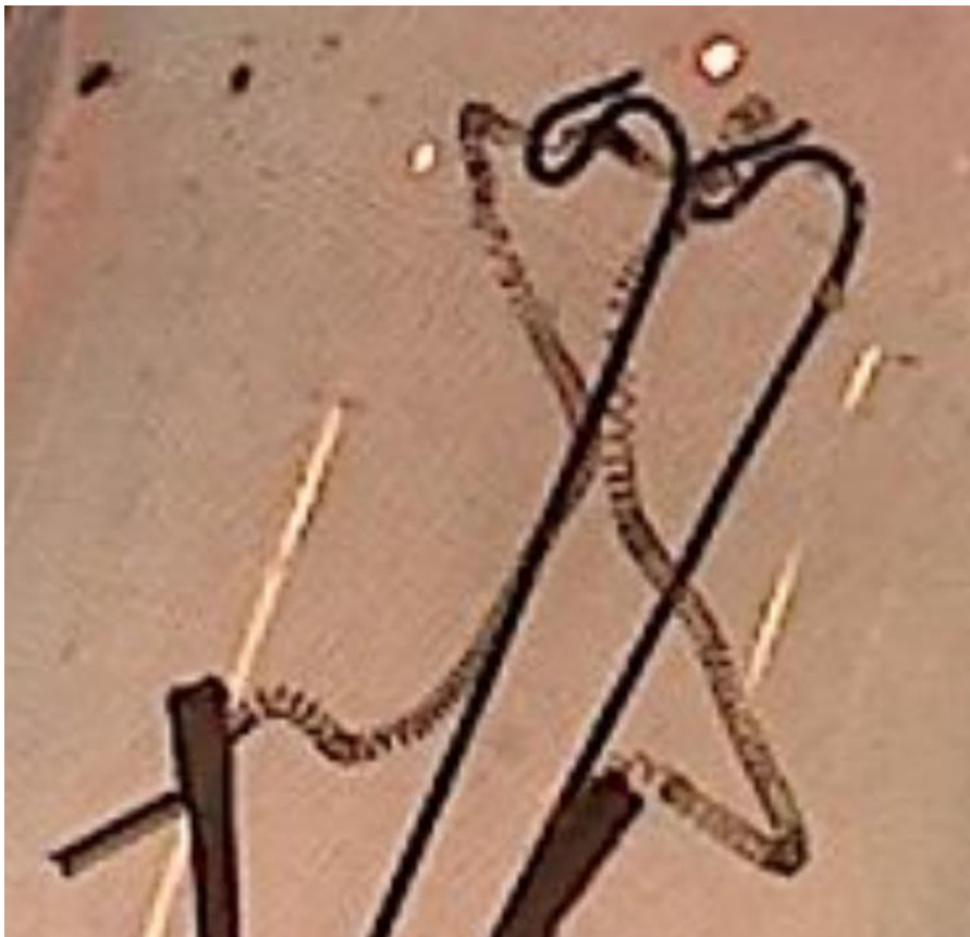
Figur 20. Förstoring av bild på varningslampan för stallvarning. Bilden visar den deformerade glödtråden.
