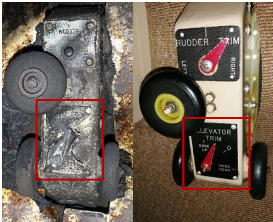
Figur 17. Bilden till vänster visar trimpanelen från vraket och bilden till höger visar en intakt panel med samma inställning. De röda rutorna visar höjdrodertrimmen.
