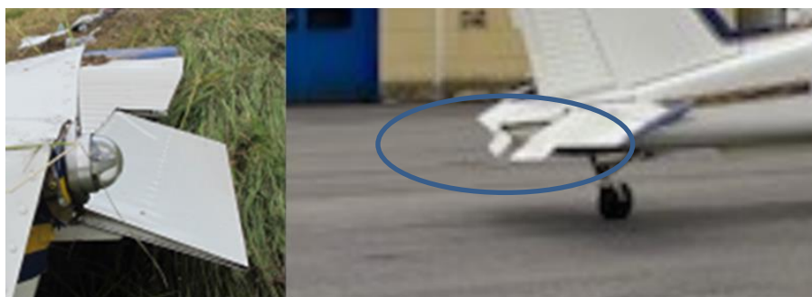
Figur 18. Den vänstra bilden visar höjdrodertrimrodrets läge efter olyckan och den högra bilden är tagen från en övervakningskamera när flygplanet taxar ut till startbanan.
