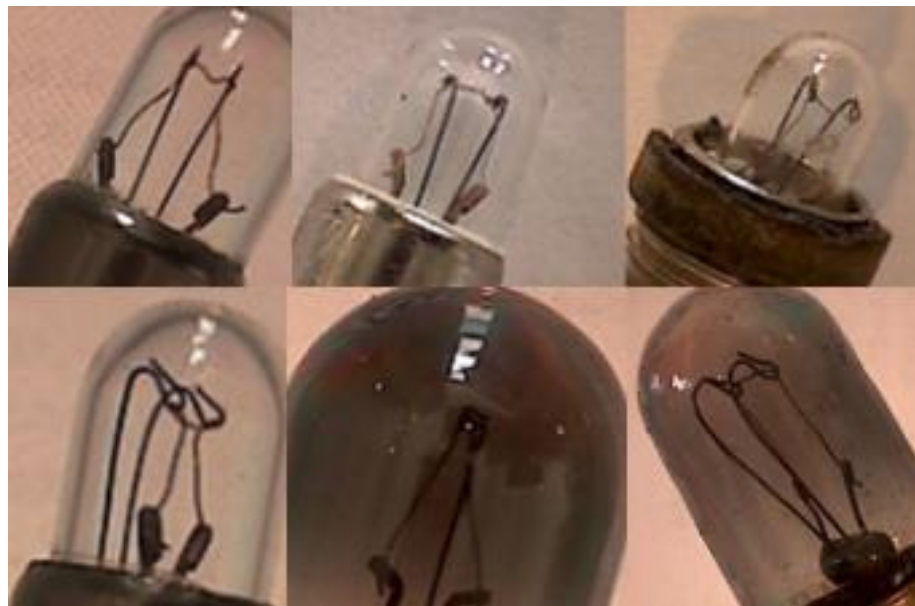
Figur 21. Glödtrådarna på dessa lampor är intakta, vilket tyder på att de varit släckta. Övre raden från vänster: Beta fail, Pitch position och Chip detect. Undre raden: Generator warning, Left low fuel pressure och Right low fuel pressure.
