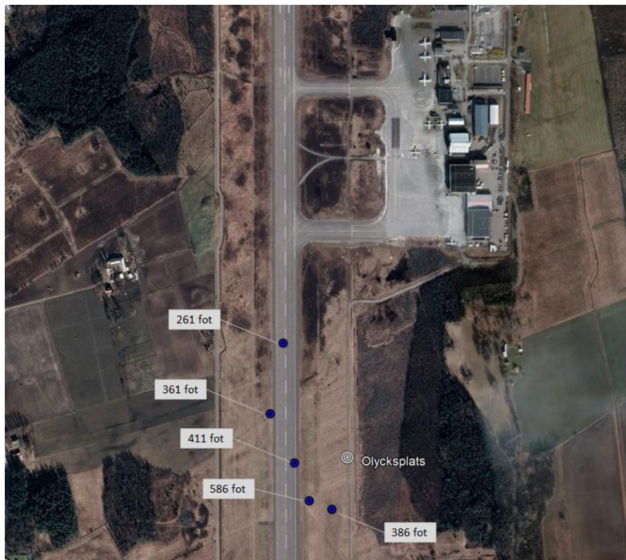
Figur 6. Flygplanets positionsregistreringar från Askersunds radar. Angivna höjder är justerade för det atmosfäriska trycket reducerat till havets medelnivå (QNH). Bild: Google Earth med markeringar infogade av haverikommissionen.
