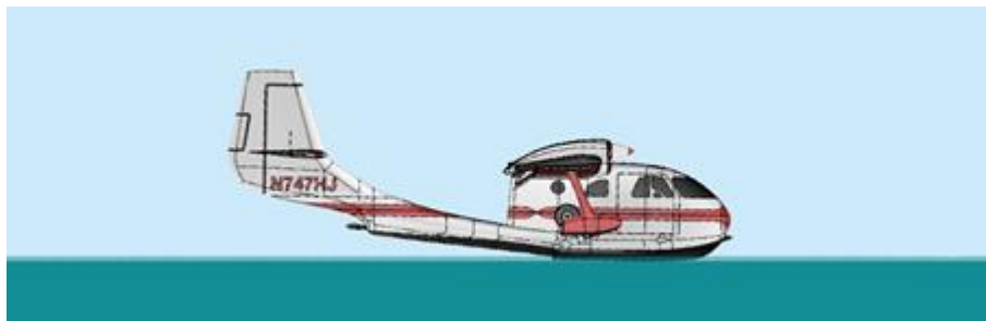
Figur 29. Flygplanets skrov får kontakt med vattenytan utan att steget bryter vattenytan.
