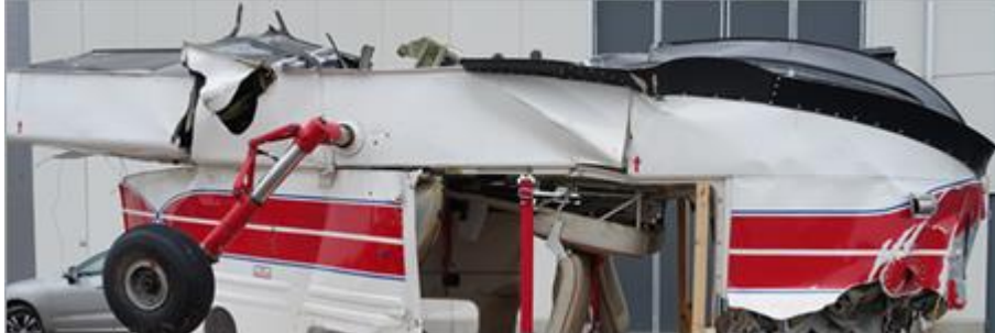
Figur 24. Vänster sida av bottenskrovets sida, kölen, nosen och kabinen. Flygplanskroppen är upp och ner på bilden.
