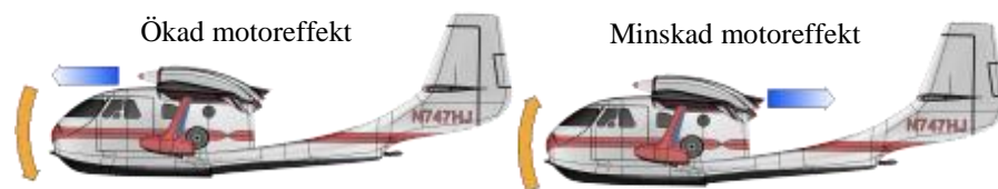
Figur 7. Attitydförändringar vid förändrad motoreffekt.
