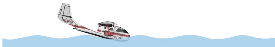
Figur 32. Principskiss, flygplanet tippas framåt och nosen trycks ner i vattnet.
