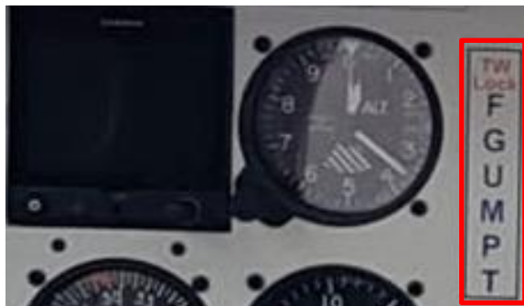
Figur 6. FGUMP(T) på instrumentpanelen markerad av SHK med röd ram. Foto: Privat.
