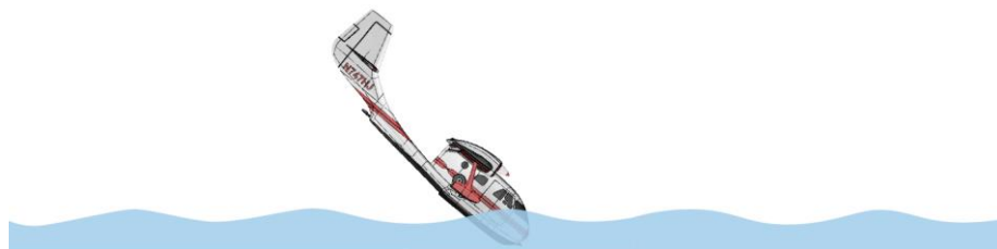
Figur 33. Principskiss, flygplanet retarderas kraftigt och tippas framåt.
