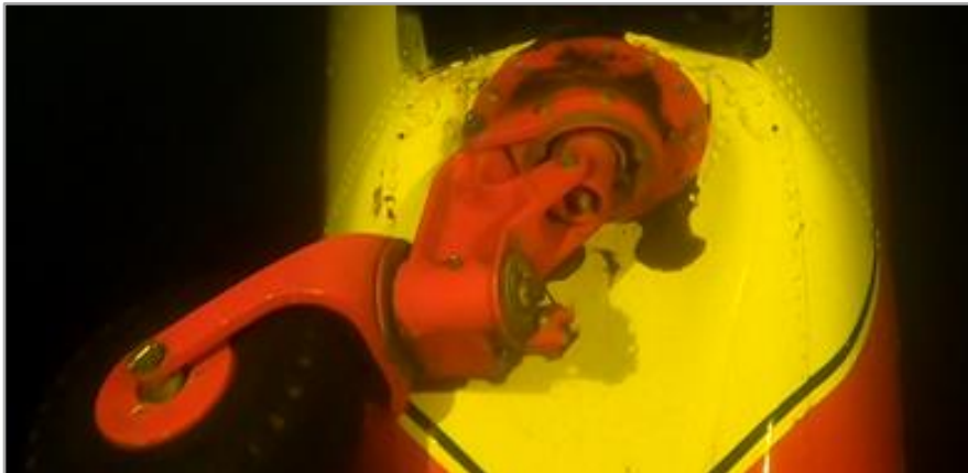
Figur 21. Sporrhjulets position vid dykningen. Foto: Polisen.
