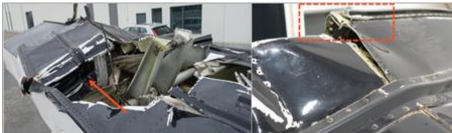
Figur 25. Vänster bild visar skadorna på kölen. Pilen visar på de bakåttryckta kölplåtarna. Höger bild visar den böjda och avbrutna köllisten. Flygplanskroppen ligger upp och ner på bilden.
