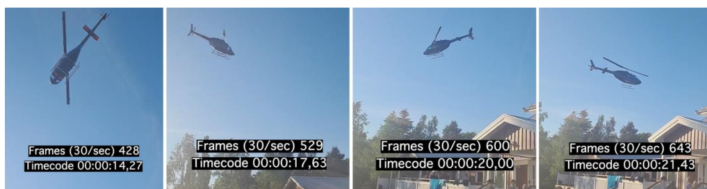
Figur 4. Bildserie som visar helikoptern i den okontrollerade rotationen åt höger. Markeringar av SHK som visar bildhastighet och tidskod. Foto: Privat.
