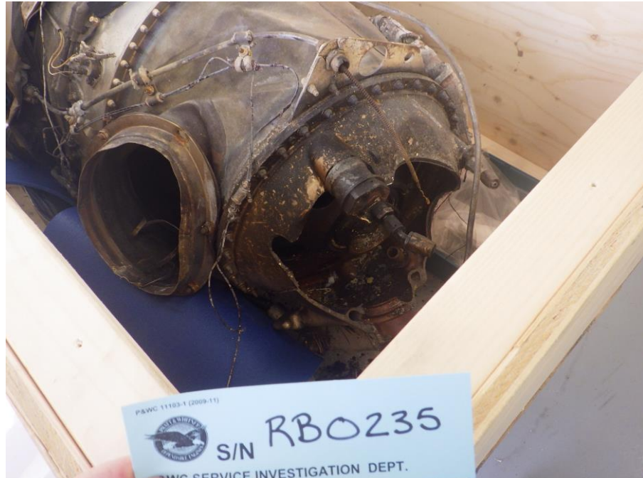
Figur 35. Den främre växellådans hölje var sprucket och exponerade insidans komponenter. Bild: Pratt & Whitney Canada Corp.
