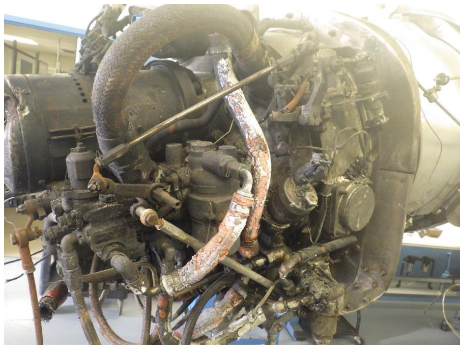
Figur 36. Hjälppapparatväxellådan hade exponerats av brand. Bild: Pratt & Whitney Canada Corp.
