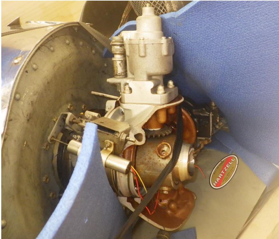
Figur 37. Propellerns övervarvsregulator och varvtalsregulator satt kvar på den del av höljet från reduktionsväxellådan som tillsammans med propellern separerade vid nedslaget. Bild: Pratt & Whitney Canada Corp.
