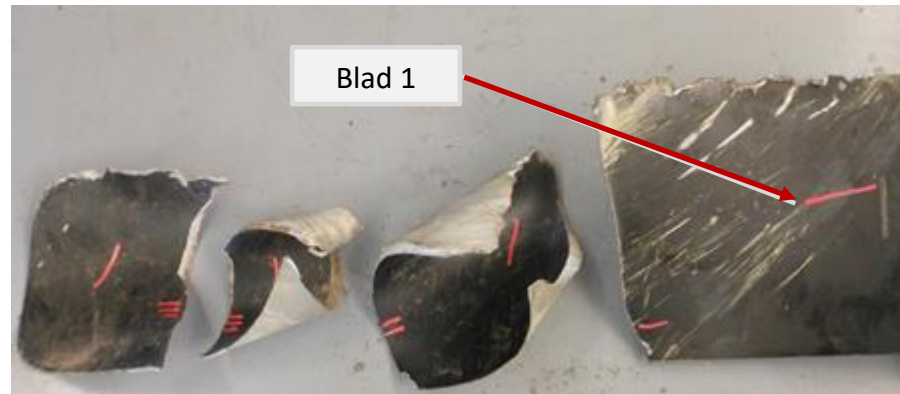
Figur 40. De tre separerade bladbitarna från propellerblad nummer ett. Markeringar införda av haverikommissionen. Bild: Hartzell Propeller Inc.
