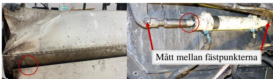
Figur 34. Den vänstra bilden visar spår av sot runt vingen och vingklaffen. Den högra bilden visar manövercylindern och fästpunkterna. Sotkanten inringat i rött.
