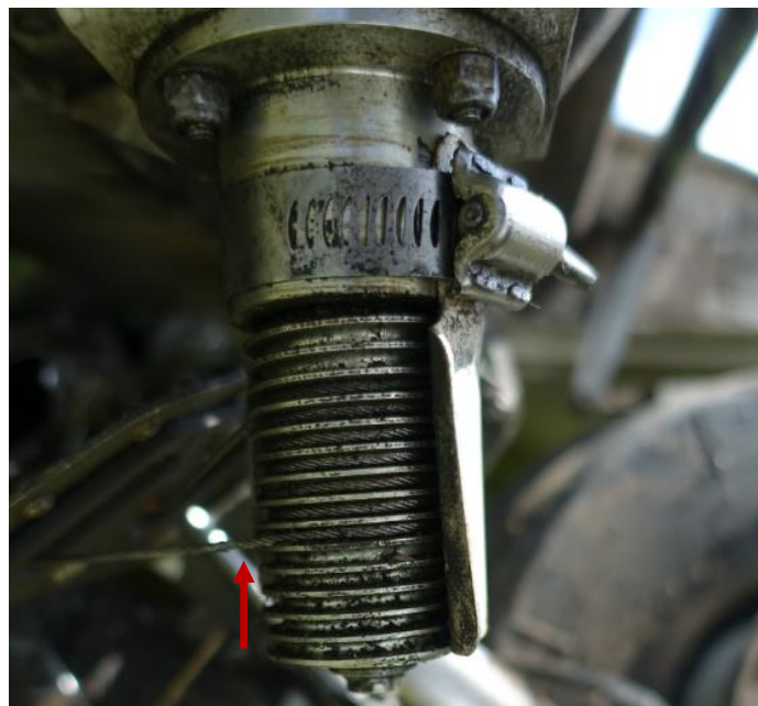
Figur 32. Höjdrtrimroderlinans position och anslutning på kabeltrumman.
