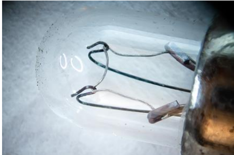
Figur 43. Intakt glödtråd utan deformation.
