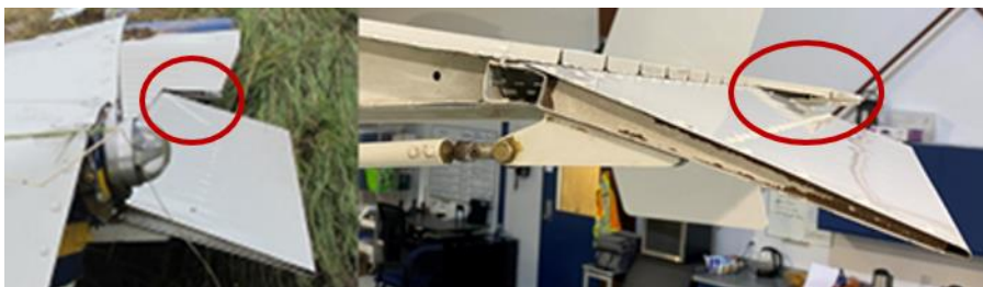
Figur 33. Den vänstra delen av bilden visar höjdrimrodrets position efter olyckan. Den högra delen visar höjdrimrodrets position vid 16.5 grader nos upp enligt typcertifikatinnehavaren.
