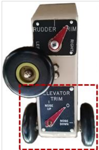
Figur 7. Trimpanelen i taket mellan pilotstolarna. Höjdrodertrimmen markerad med en streckad röd ruta. Visaren indikerar "0".
