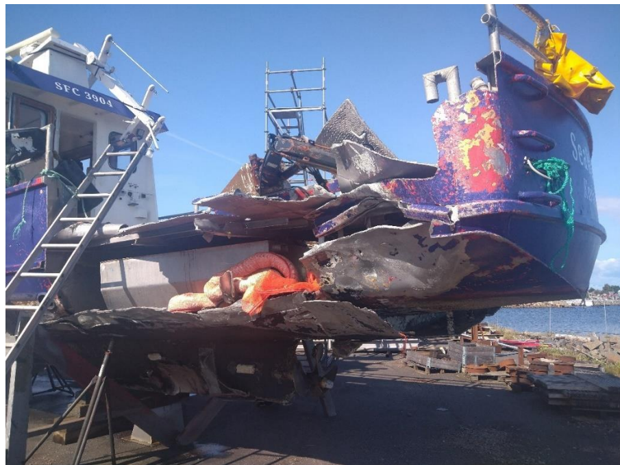
Figur 3. Aktra delen av babordssidan. En del av skrovsidan hade slitits bort helt och hållet.
