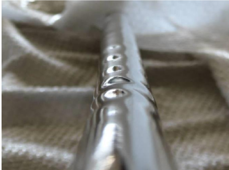
Figur 16. Vågformig buckling till följd av vridning.
