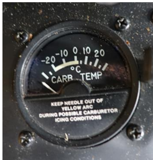
Figur 26. Instrumentet för temperatur i förgasaren (Carb Temp).
