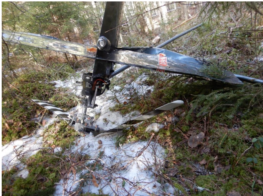
Figur 12. Stjärtrotor med drivaxel och fena. Skador på vänster sida av fenan och stjärtrotornavet.
