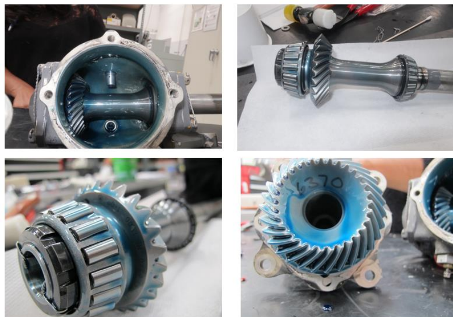
Figur 22. Stjärtrotorväxel med komponenter.
