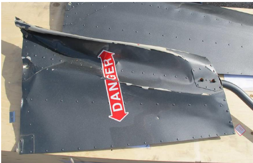
Figur 20. Skador på den nedre fenan.
