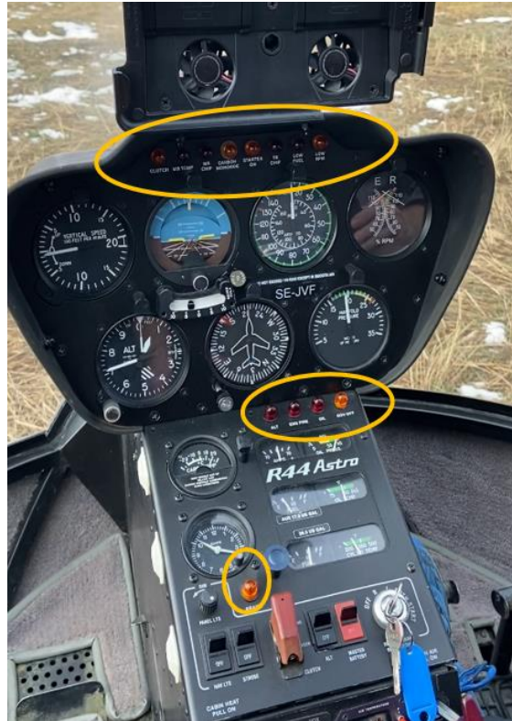
Figur 23. Varningslampornas placering på instrumentpanelerna. Bild från starten av flygningen. Markeringar infogade av SHK. Bild: Privatperson.
