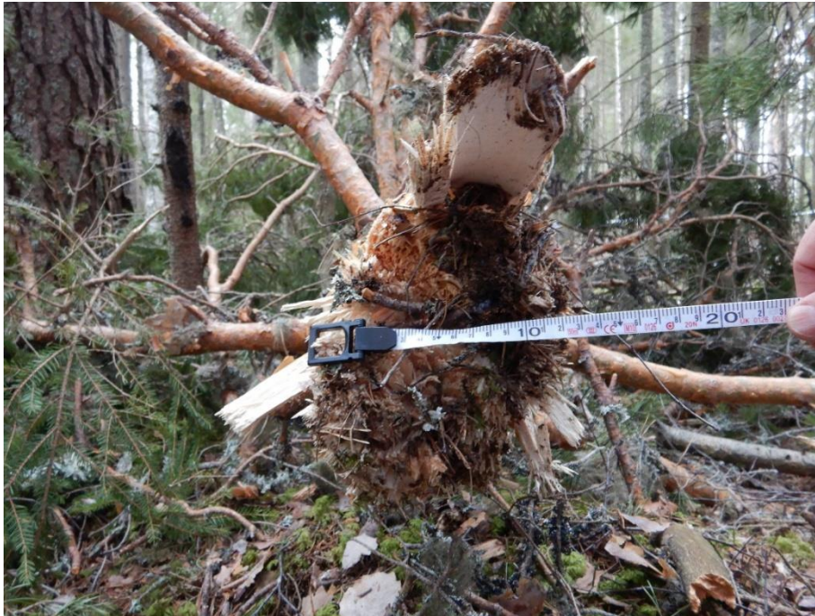
Figur 13. En av trädstammarna som kapats av huvudrotorbladen. Trädets diameter 13 centimeter.
