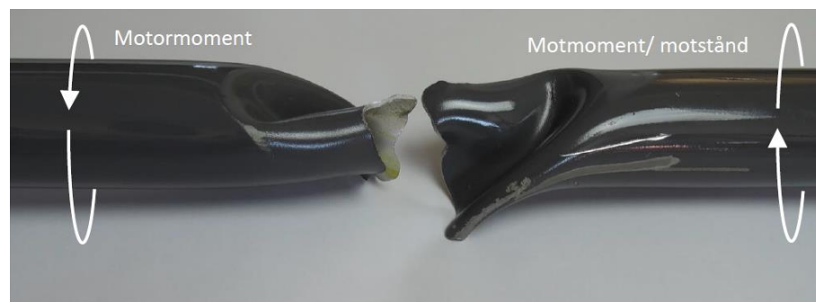
Figur 17. Brottet med belastningsriktning.
