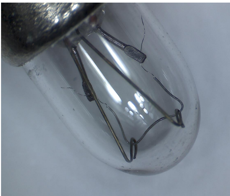
Figur 25. Varningslampa för lågt oljetryck i motorn med oskadad glödtråd.
