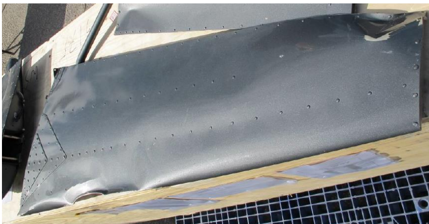
Figur 19. Skador på övre fena.
