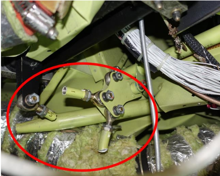
Figur 27. Brutna stötstänger för styrsystem för girkontroll i området under pedalerna.
