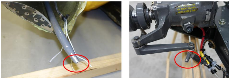
Figur 28. Den avbrutna stötstängen vid stjärtrotorn.
