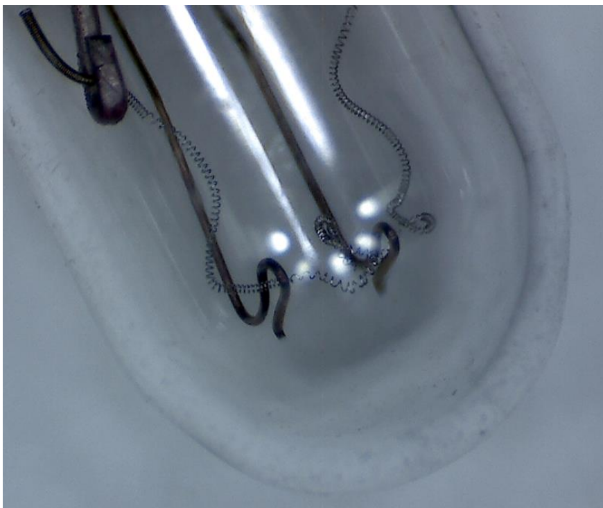
Figur 24. Varningslampan för låg spänning med sträckt glödtråd.
