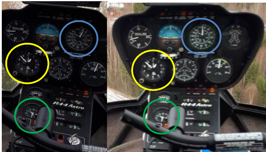
Figur 3. Indikerad fart (blå markering). Höjd (barometrisk höjd över havet i fot, gul markering) är densamma vid båda tillfällena. Klockan på instrumentpanelen (grön markering) var inte inställd på korrekt tid. Bilderna är beskrivna av haverikommissionen. Bild: Privatperson.
