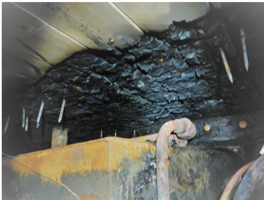
Figur 15. Kraftig förkolning ovanför styrbords bränsletank. En del av den större remskivan på remtransmissionen syns i nedre högra hörnet.
