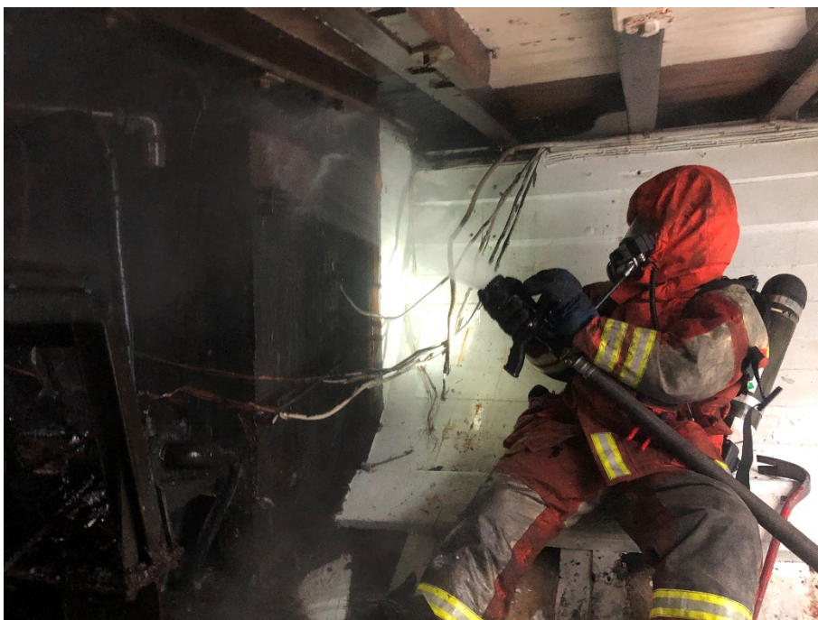
Figur 8. Släckning från lastrummet av glödbränder under däckets ovanför motorrummet. Rester av skottet som kapats mot motorrummet kan ses till vänster om rökdykaren. Foto: Kustbevakningen.
