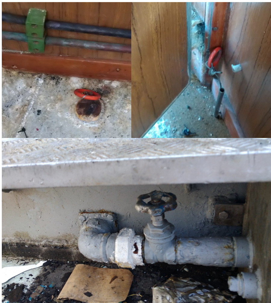
Figur 2. De röda ringarna i de övre bilderna var för nödavstängning av bränsleledningarna till motorn. De satt i styrhyttens golv på vardera sida i hytten. I den nedre bilden syns avstängningskranen för hydraultanken som fanns under fotsteget in till styrhytten.
