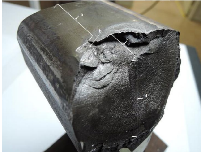
Figur 17. Bilden visar brottyta 1.2 med farkantsprickor (a), urflisning (b), parallellspricka (c) och vertikalspricka (d).
