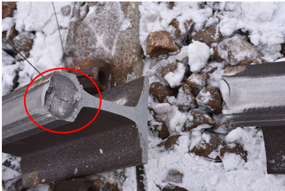
Figur 6. Tecken på föregående sprickbildning i rälhuvudet vid den första brottytan i färdriktningen.
