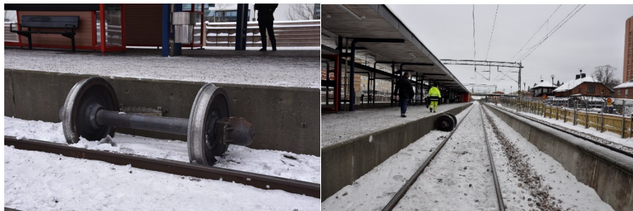
Figur 10. Vid Sollentuna pendeltågsstation, 600 meter efter rälsbrottet, återfanns den sista hjulaxeln från den sista godsvagnen liggandes utmed plattformskanten.
