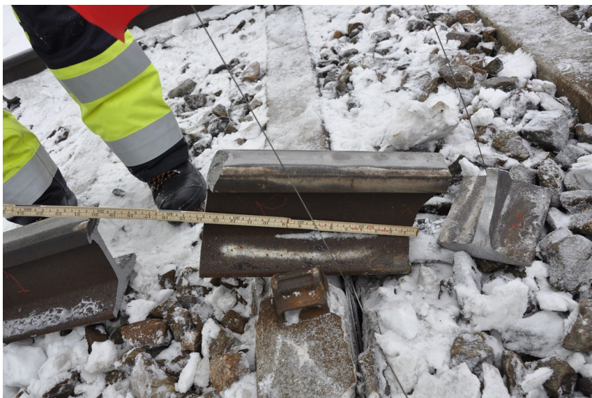
Figur 7. Vit sprayfärg på en av räldelarna vid rälsbrottet.
