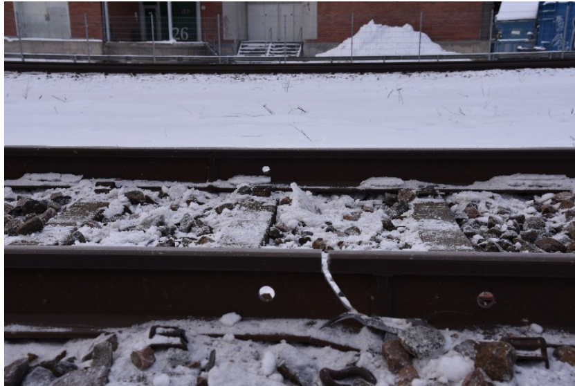
Figur 9. Mindre brott på rälen mellan det större rälsbrottet och Häggvik.
