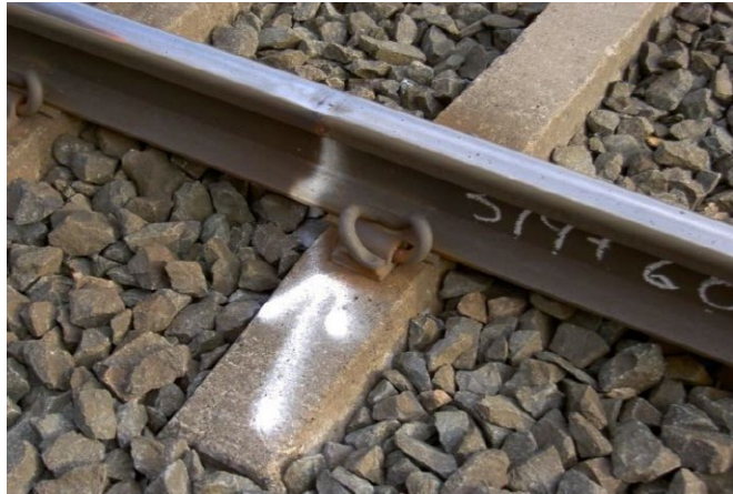
Figur 32. Utdrag från Infranord Mätenhetens arbetsinstruktion Manuell OFP av räler och rälskomponenter i spår . Exempelbild på hur fel utan utbredning i längdriktningen ska markeras i anläggningen. Källa: Infranord Mätenheten
