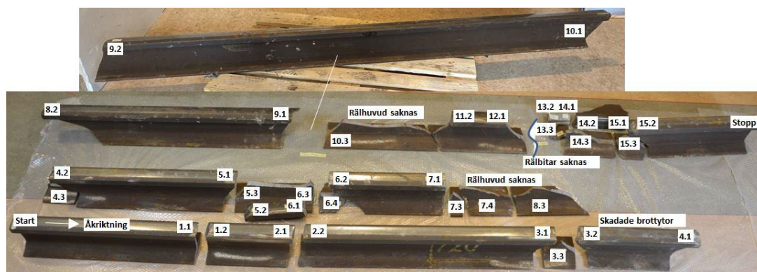
Figur 16. Bilden visar räldelar lagda i ordningsföljd samt numrerade brottytor.
