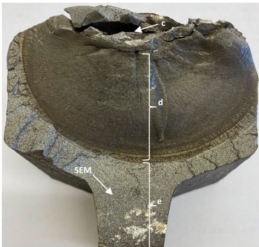
Figur 22. Brottyta 1.1 med parallellspricka (c), vertikalspricka (d) och restbrottzon (e). SEM markerar det område som undersökts med svepelektronmikroskop.
