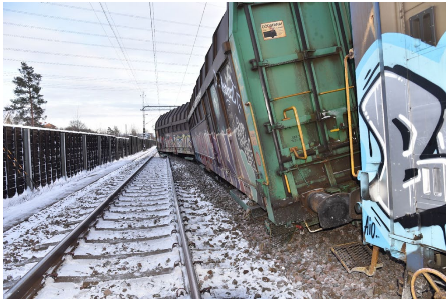
Figur 4. Den sista vagnen stannade förskjuten i sidled med bakre delen i det intilliggande spåret. Fotografen står med ryggen mot tågets färdriktning.
