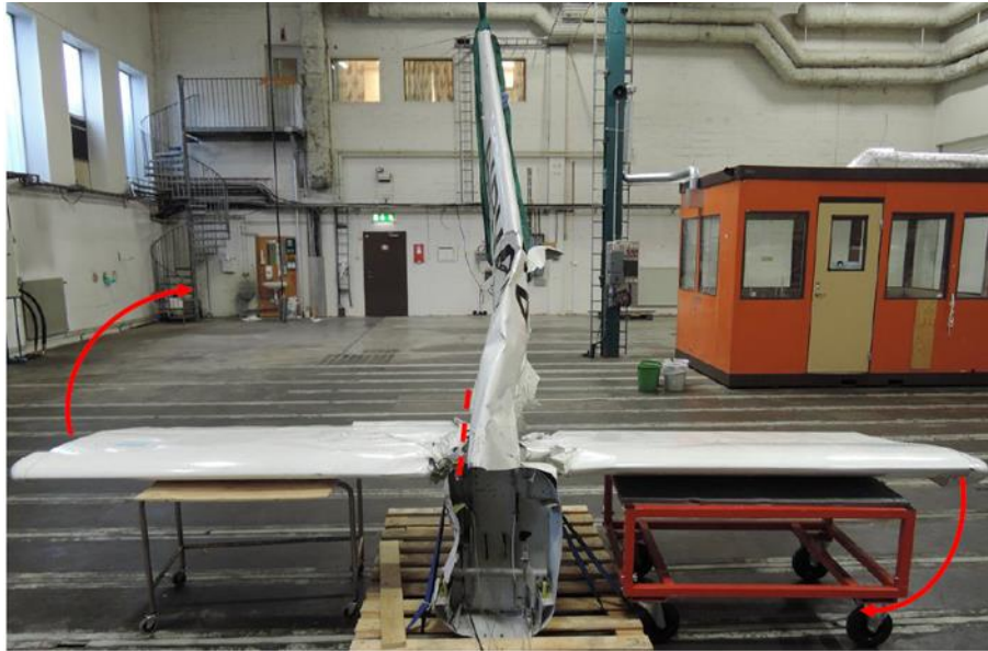
Figur 46. Sekvens av brotten av stabilisatorn och fenan.
