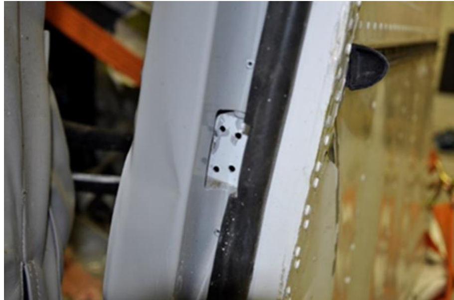
Figur 58. Bilden visar att pilotdörrens låsclack slitits ur sitt fäste.
