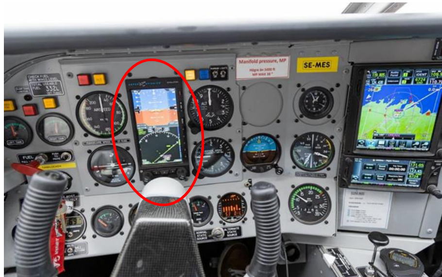
Figur 12. Flyginstrumenten i SE-MES med Aspen PFD-skärmen (markerad med röd ring av haverikommissionen) och de konventionella flyginstrumenten. Foto: Klas Sjöberg.
