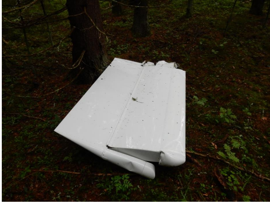
Figur 30. Avbruten del av stabilisatorns vänstra sida.
