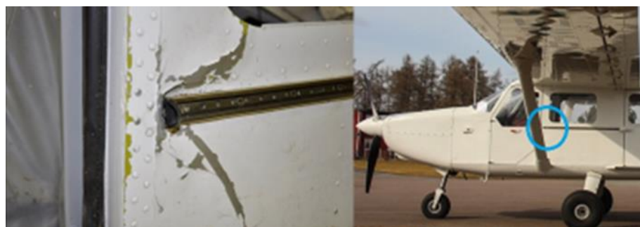
Figur 55. Vänster bild: Visar skador på skrovet vid dörrens främre position i öppet läge. Höger bild: Markering av haverikommissionen som visar skadornas position på flygkroppen. Foto: Krister Karlsmoen.
