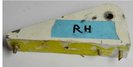
Figur 42. Konsolerna och infästning mot stabilisatorn. Höger övre bild: GippsAero Pty Ltd SB-GA8-2002-02 Figure 2.
