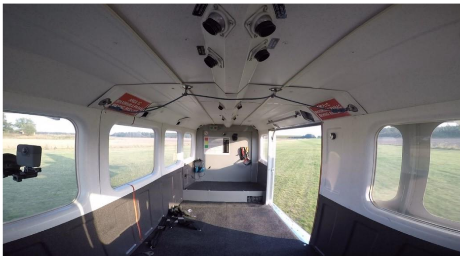
Figur 10. Bild på kabinen tagen från cockpit på ett annat flygplan av samma typ. SE-MES var inte utrustat som flygplanet på bilden, det fanns inga säkerhetsbälten eller rep i taket att hålla sig i. Den förhöjda golvdelen ( bagagehyllan ) längst bak får enligt typcertifikatinnehavaren inte användas vid fallskärmschoppning.
