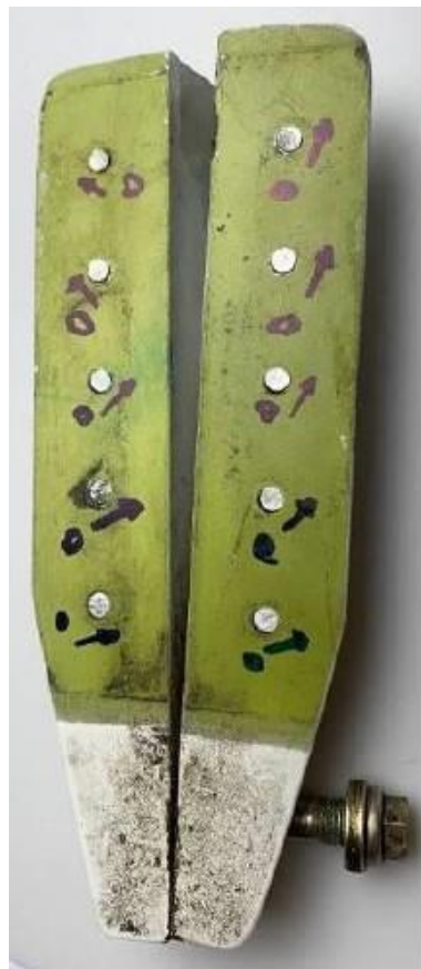
Figur 43. Konsol för främre infästning av stabilisatorn.
