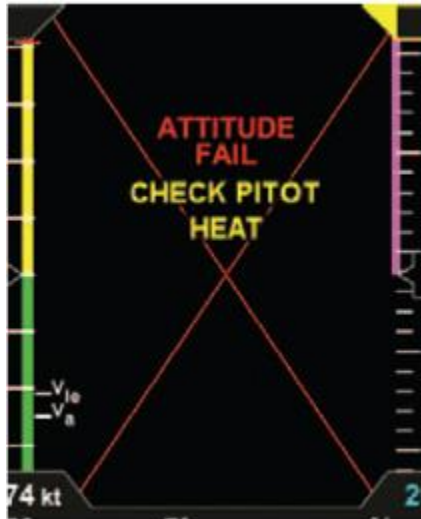
Figur 14. Indikeringen i den primära flyginformationsskärmen vid blockerat pitot eller statiskt system. Bild: Aspen Avionics Inc.
