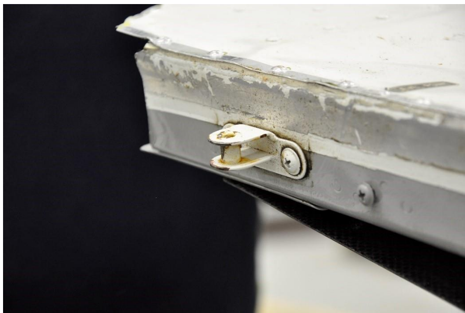
Figur 57. Kabindörrens låstapp på flygplanskroppen.
