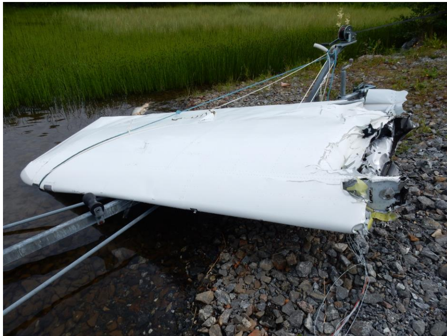
Figur 31. Ytterdelen av höger vinge bärgades från Umeälven.
