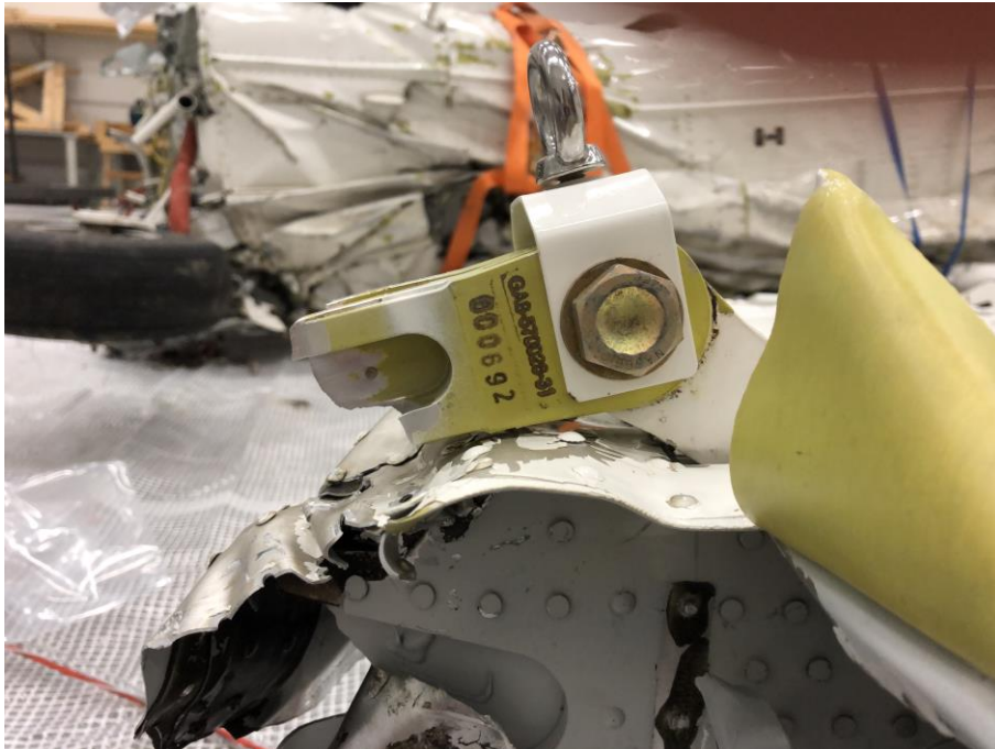
Figur 37. Den avbrutna infästningen för höger vingstötta.
