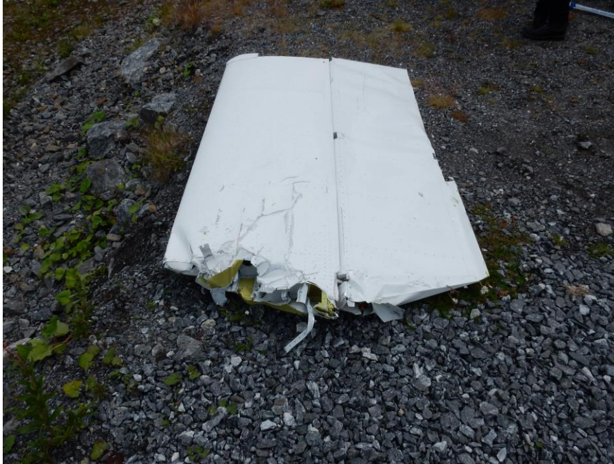
Figur 32. Höger del av stabilisatorn bärgades från Umeälven.
