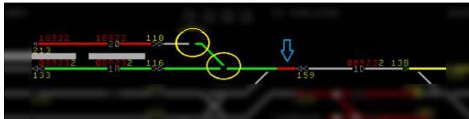
Figur 12. Tåg 8923 markerat med en blå pil befinner sig på spårledning 132. Växel 417a och spårspärren i de gula ringarna har låst upp och börjat att läggas om.
