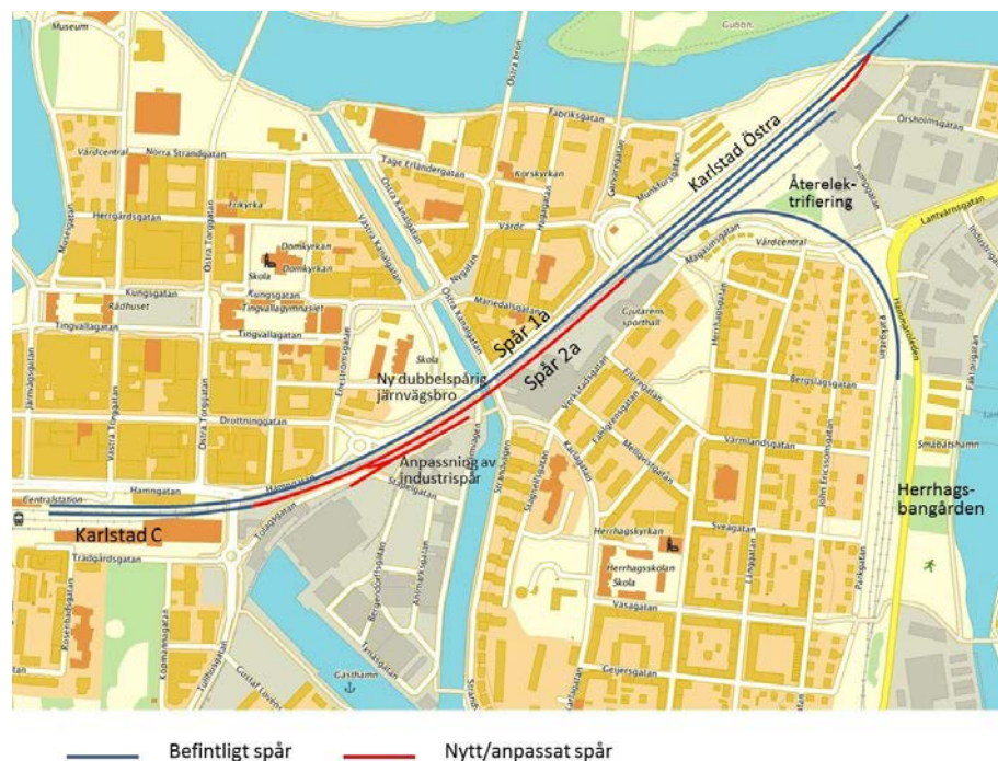
Figur 3. Skiss ur AKJ för Pråmkanalen med det anpassade/nya spår 2a i rött. Källa: Trafikverket.
