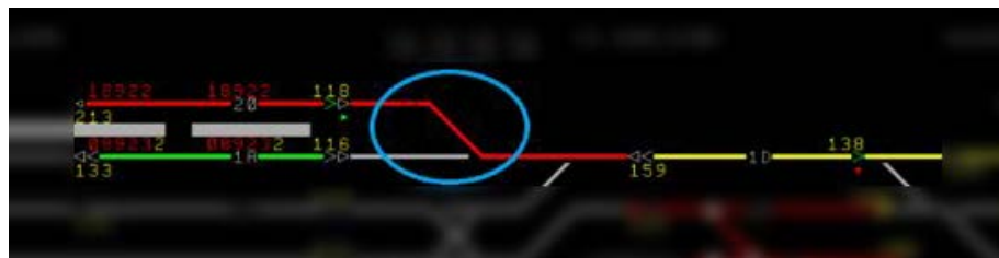
Figur 13. Bilden visar att växel 417a och spårspärren i den blå ringen lagts om och en växlingsväg ligger för tåg 18922 från spår 20 (indikeras med en grön vinkel/pil för signal 118). Tåg 8923 befinner sig till före (till höger om) växel 417a.
