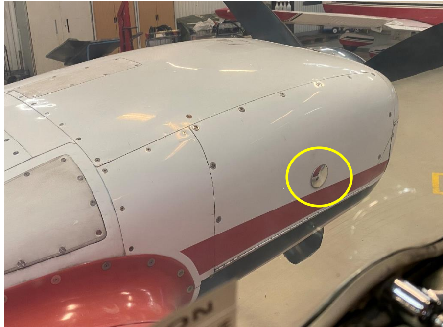
Figur 4. Installerad spegel på vänster motorgondol för att se noshjulets position.
