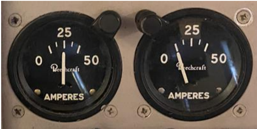
Figur 8. Belastningsmätarna i SE-LUX. Höger mätare visar 0 ampere.
