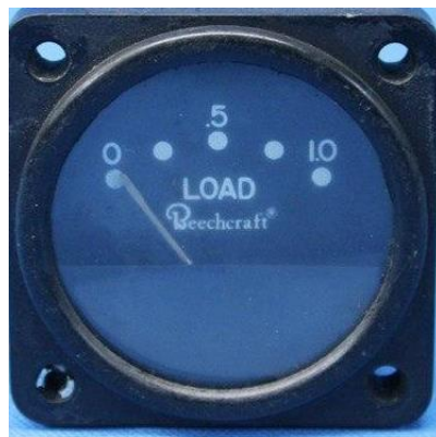
Figur 11. Belastningsmätare som flyghandboken hänvisar till (inte installerad i SE-LUX).
