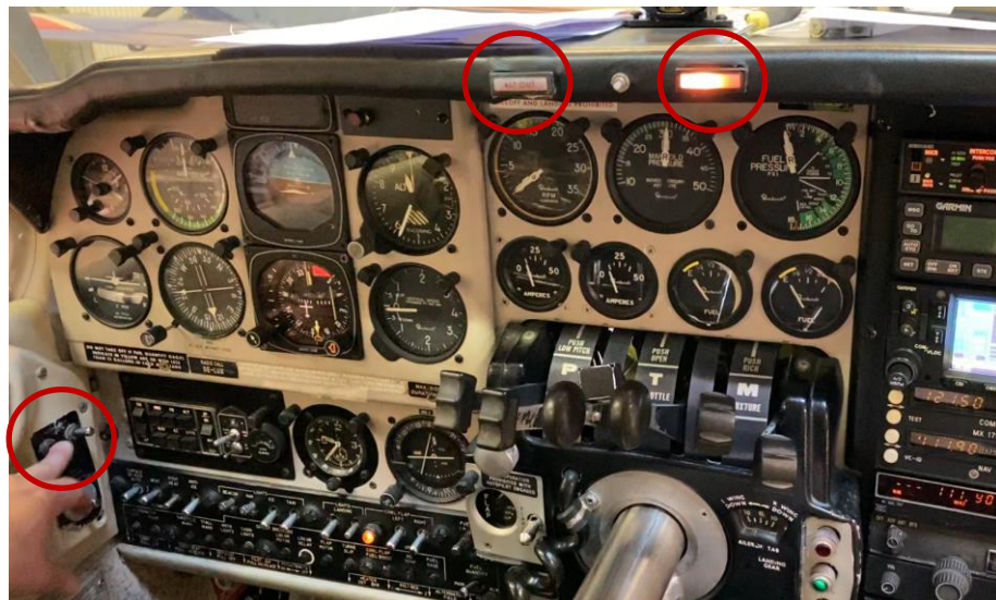
Figur 7. Bilden visar att vänster ”ALT OUT” släcks då strömställaren för vänster alternator är i läge OFF.
