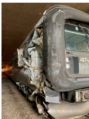
Skador på växlingsrörelsens front. Foto: ISS.
