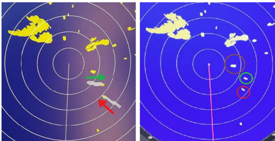
Figur 19. Bilden till vänster visar en radarbild med påslagen spårfunktion. Röd pil är SILVERPILEN, grön pil är JÄGAREN. Bilden till höger visar radarbilden vid samma tillfälle men utan spårfunktion. Röd ring är SILVERPILEN, grön ring är JÄGAREN, översta bruna ringen är en ö.
