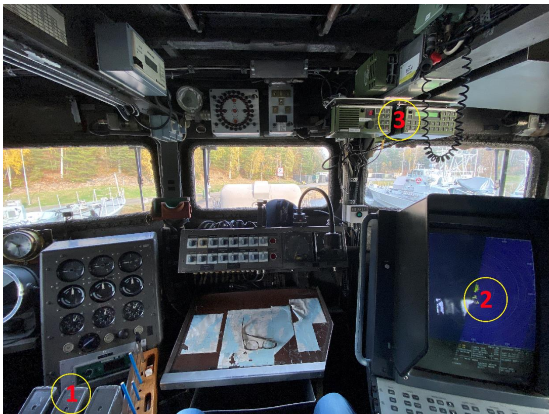
Figur 12. Vy, ombord på YSTAD, från styrmannens plats i mitten av styrhytten. Till vänster satt rorgångaren och till höger satt befälhavaren. Reglagen och instrumenteringen för de tre huvudmaskinerna sitter till vänster (1). Radarskärmen till höger, vinklad in mot mittenplatsen (2). VHF-radion ovanför fönstren (3).
