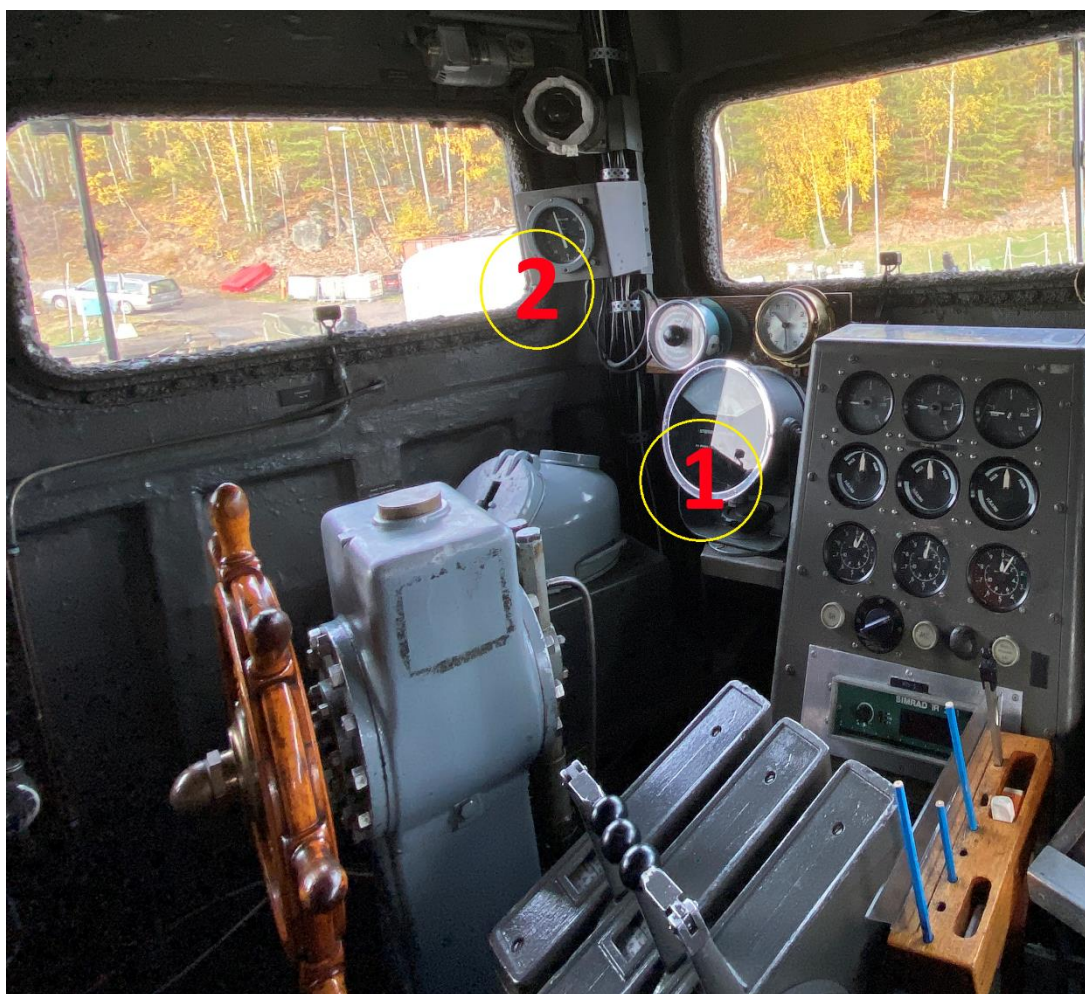
Figur 11. Rorgångarplatsen ombord på YSTAD. Fartyget styrs för hand med en traditionell trärratt. Till sin hjälp har rorgångaren en gyrokompass (1) och en roderlägesvisare (2).
