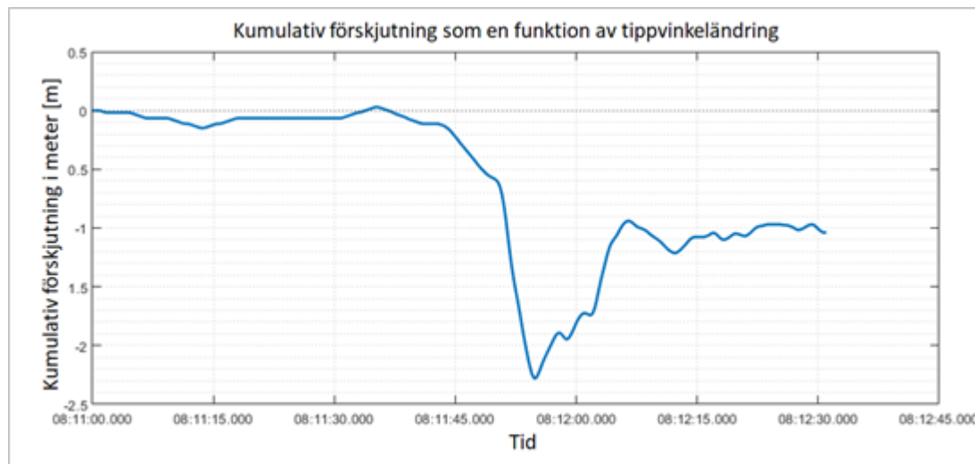
Figur 17. Den ackumulerade förskjutningen av golvet i det bakre pentryt på passagerarflygplanet som en funktion av tippvinkeländringen över tid.
