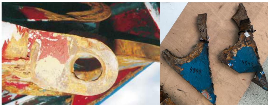
Fig. 3.10 and fig. 3.11. Fig. 3.10 (vänster) visar bottenlåsörat på visiret. Fig. 3.11 (höger) visar de brustna bottenlåsöronen på skrovet, i det skick de befanns i februari 2025. Bild vänster: JAIC fig. 8.10.
