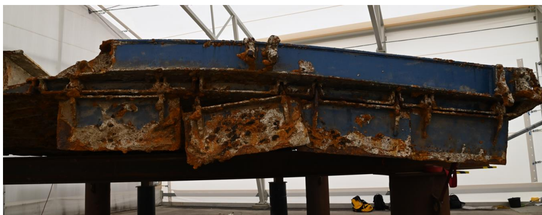
Fig. 3.5. Den förliga bildäcksrampen med babords sida till höger (rampen är upp-och-ner på bilden). Fyra plåtar sitter fortfarande kvar i sina gångjärn i rampen. Bilden är beskuren.
