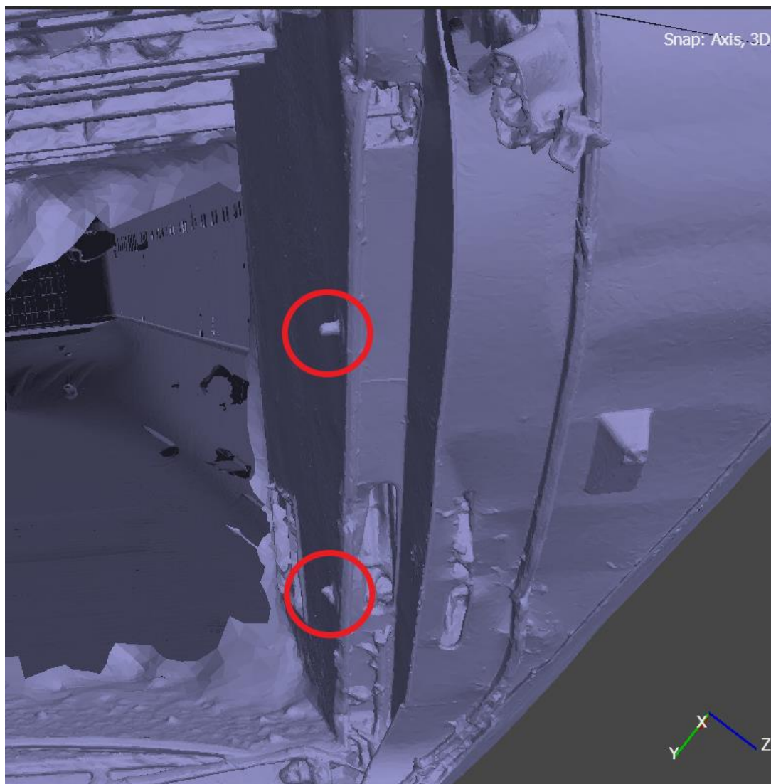
Fig. 3.1. Bilden är från fotogrammetrin 2022 och visar båda babordsrampläsningarna som sitter på skrovdelen. Den nedre är inte i helt utskjutet läge. En dykaren 1994 uppskattade den utskjutna delen till ca 3 cm ("1.5 inches") i stället för dess fulla längd (omkring 15 cm). Om detta var läget vid avgång från Tallinn skulle grönt ljus inte indikerats på panelen vid avgången.
