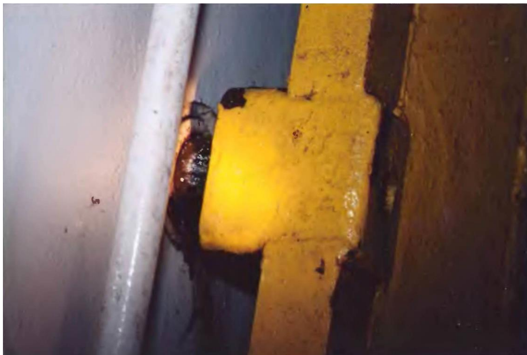
Fig. 3.6. Bilden visar bogrampens nedre låsning, sedd från bildäcket. Själva låsningen är på inne i serviceutrymmet (på andra sidan av det vitmålade skrovskottet eller skrovväggen). Vid låsning eller skalkning trycks låskolven hydrauliskt ut (mot höger i bild) in i det gula, korresponderande låshuset på rampen, och vid upplåsning trycks låskolven hydrauliskt ut ur det gula låshuset och in i serviceutrymmet (mot vänster i bild). Detta visar att det inte är möjligt att slå på låsningen från bildäck. Det skulle emellertid vara möjligt att slå på det gula låshuset om kolven kärvar, och därmed få den att lossa medelst vibrationerna. Bilden är från MARE BALTICUM. Jämför med fig. 3.3 ovan.
