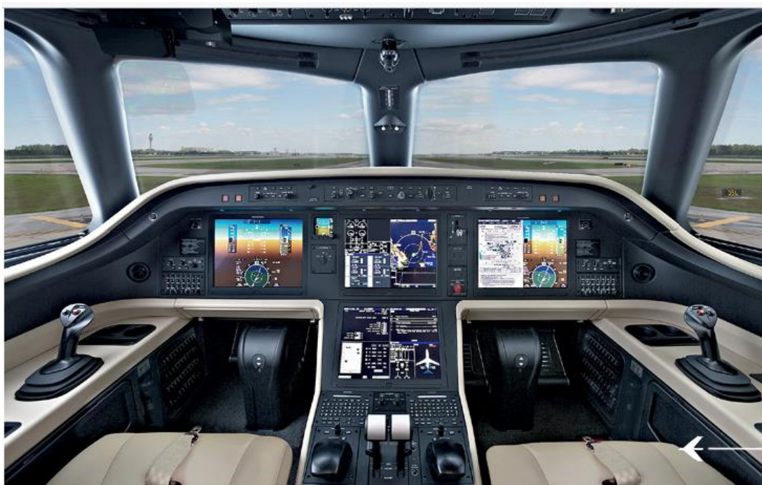
Figur 1. Utformning av Cockpit. Skärmar visar flyginstrument och systeminformation. Bild: Embraer.
