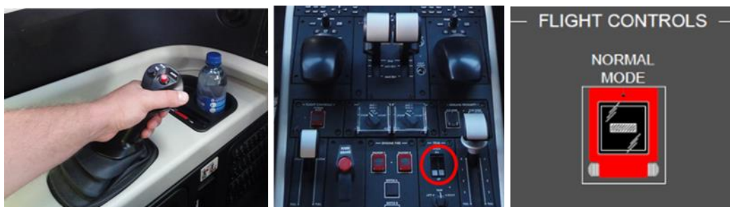
Figur 2. Vänsterpilotens styrspek för tipp och roll, det manuella tipptrimreglaget (Pitch Trim) på den centrala piedestalen, och knappen märkt Flight Controls NORMAL MODE (en röd lampa lyser i knappen när systemet är i DIRECT MODE). Röd ring infogad av SHK. Källa: Embraer.
