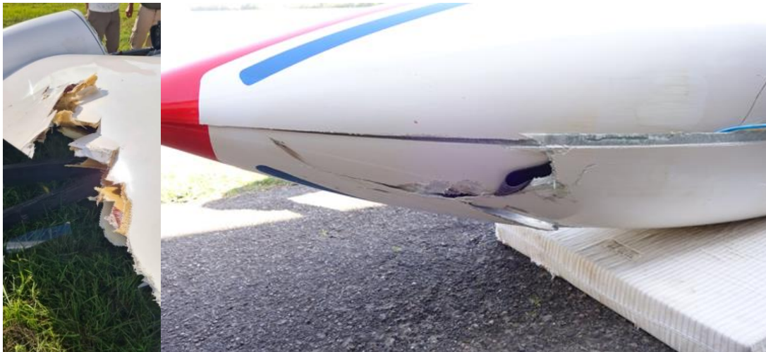
Figur 6. Vänster bild visar skadorna på höger vinge och höger bild visar skadorna på flygplanskroppen fram till hjulet.
