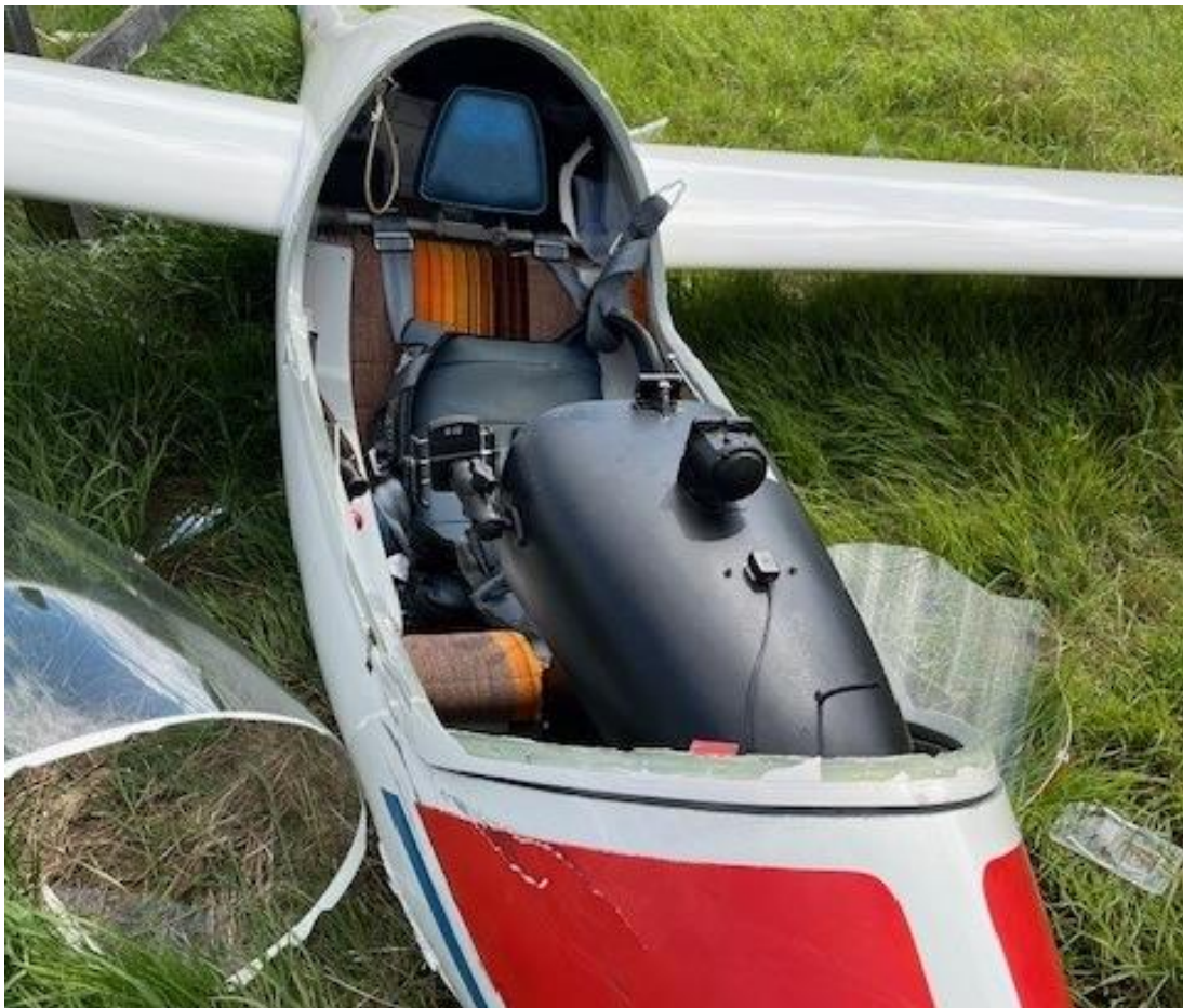
Figur 7. Bild på kabin och den krossade huven.
