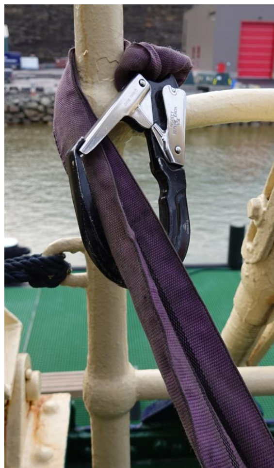
Figur 6. Bilden är en rekonstruktion och visar hur arrangemanget var kopplat vid händelsen, och hur karbinhaken var fastgjord i det lila lastslinget. Till skillnad från bilden var slinget vid händelsen på utsidan av räckverket.
