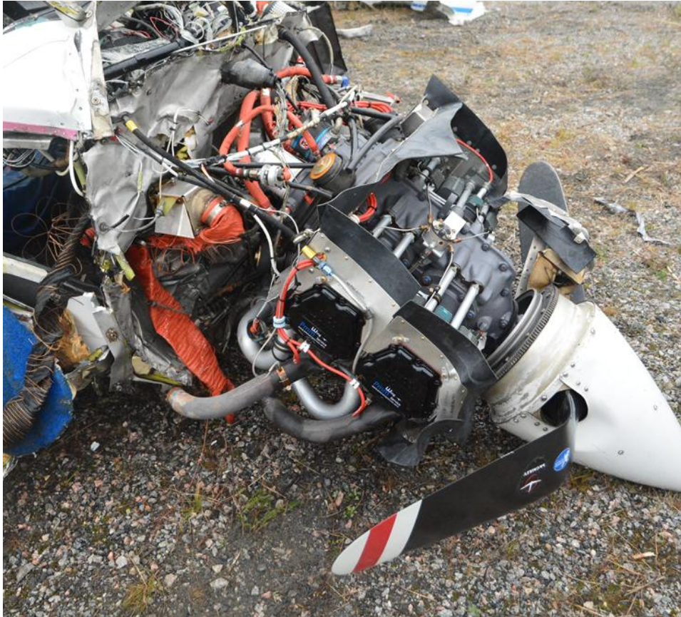
Figur 17. Bilden visar skadorna på motorupphängningen och hela motorinstallationen.
