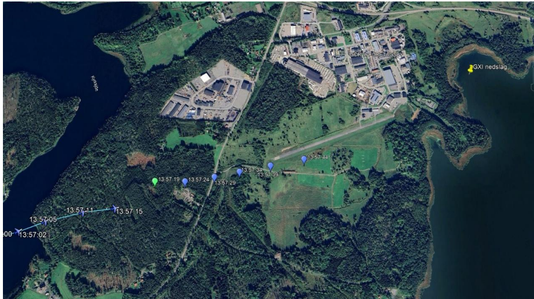
Figur 4. Sista delen av flygningen som registrerades av FR24 och LFV:s radar. LFV:s sensorpunkter markerade som punktmarkeringar. Den gröna sensorpunkten har en registrerad höjd på 300 fot. De blå punkterna har en registrering på 200 fot. Avståndet mellan den sista transponderregistreringen till haveriplatsen beräknas till 1 288 meter. Tidsangivelsen på ADS-B data är i UTC. Källa: FR24, LFV och Google Earth.
