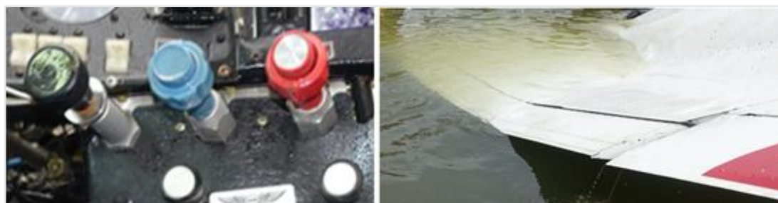
Figur 10. Vänster bild visar lägen för motorreglagen (gasreglage i svart, propellerreglage i blått och bränsleblandningsreglage i rött). Höger bild visar klaffen i infällt läge.
