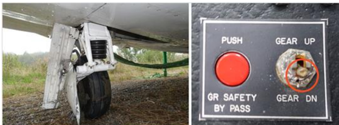
Figur 9. Vänster bild visar huvudstället, utfällt och låst. Höger bild visar ett avbrutet landställsreglage i position landställ ner, markerat med en röd cirkel.
