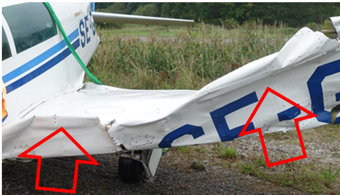
Figur 16. Närbild av skadorna på vänstervingens framkant. Pilarna visar den ungefärliga riktningen på de hydrodynamiska krafterna.
