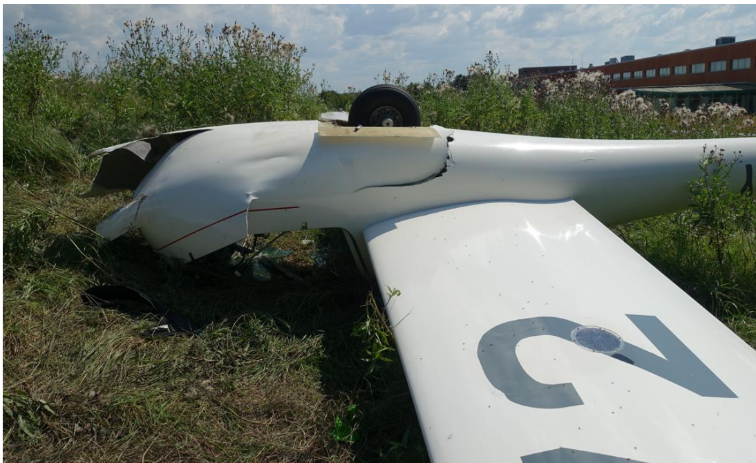
Figur 14. Skador på nosparti och främre delen av flygkroppen. Strukturen var delvis intakt kring platsen för pilotens överkropp.
