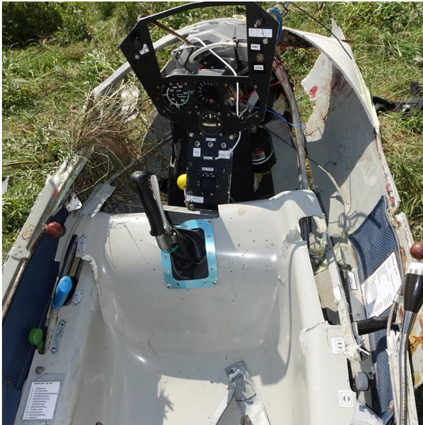
Figur 15. Skador på främre delen av cockpit och nosparti. Segelflygplanet visas här rättvänt i samband med bärgningen.
