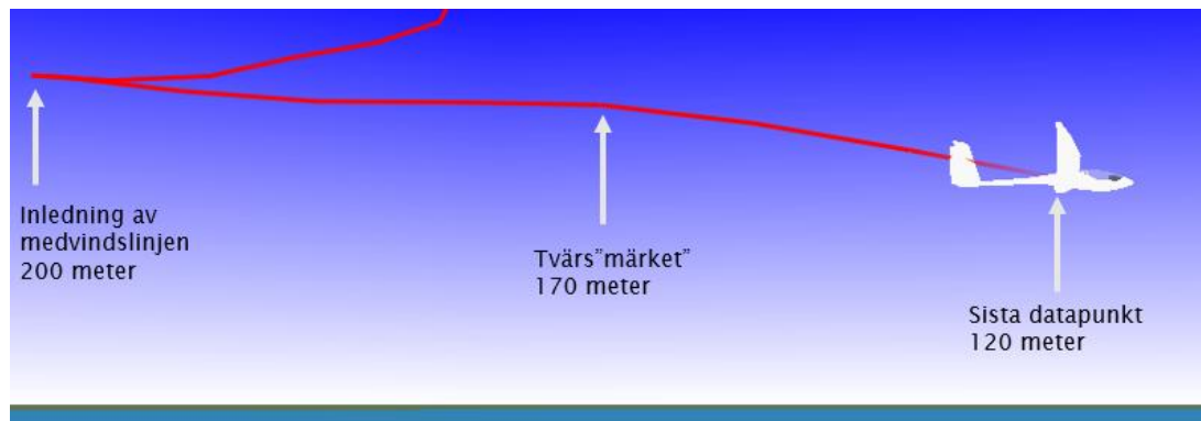
Figur 10. Bilden visar den vertikala profilen av segelflygplanets flygbana längs medvindslinjen. Angivna höjder i meter över marken. Under den senare delen av medvindslinjen blev flygbanan brantare. Bild: SeeYou. Markering infogad av SHK.
