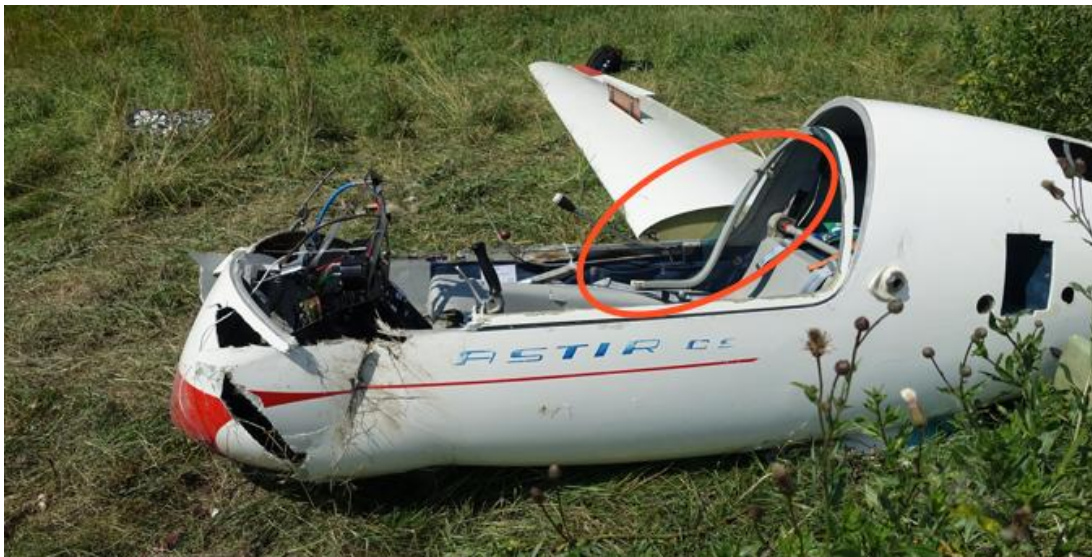
Figur 16. Nosparti och cockpit hos segelflygplansvraket. Cockpitens utrymme för en pilots överkropp markerad med röd ring. Bilden är tagen i samband med bärgningen med flygplanet rättvänt och vingarna demonterade.
