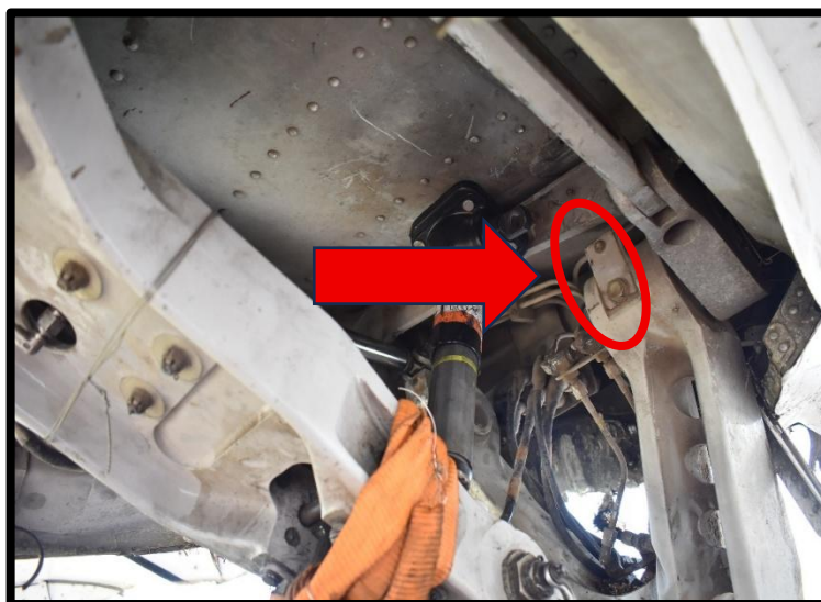
Fotografía No. 10 Soporte del actuador hidráulico que actúa el tren de aterrizaje derecho.
