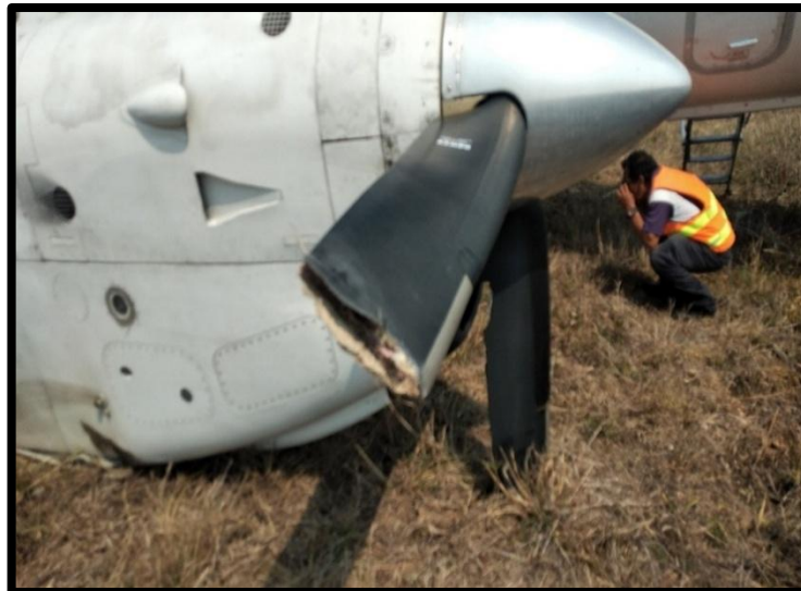
Fotografía No. 4 Vista de las aspas quebradas de la hélice derecha.
