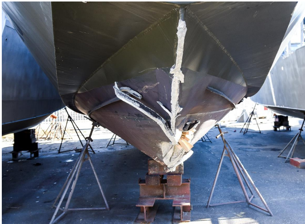
Figur 8. Bild som visar skador på båtens stäv.
