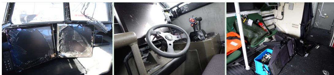
Figur 9. Vänstra bilden visar navigatörens plats och de krossade bildskärmarna. Mittenbilden visar båtförarens plats och den skadade styrratten. Den högra bilden visar båtschefens stol som hade lossnat och hamnat på golvet.
