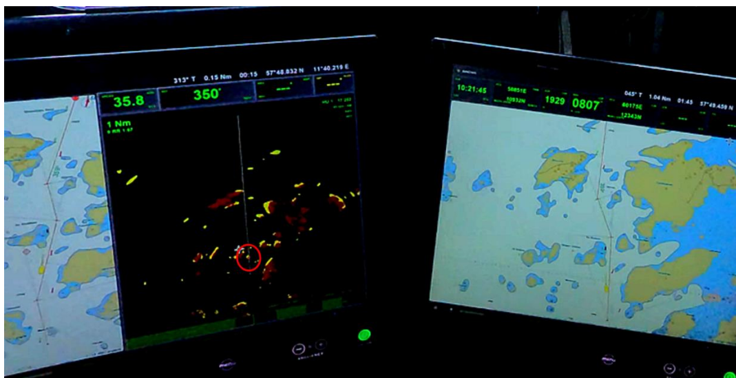
Figur 18. Bild som visar radarpresentationen under provturen strax innan passage av sundet vid Snippeskären. Den röda ringen införd av SHK visar ön för grundstötningen.
