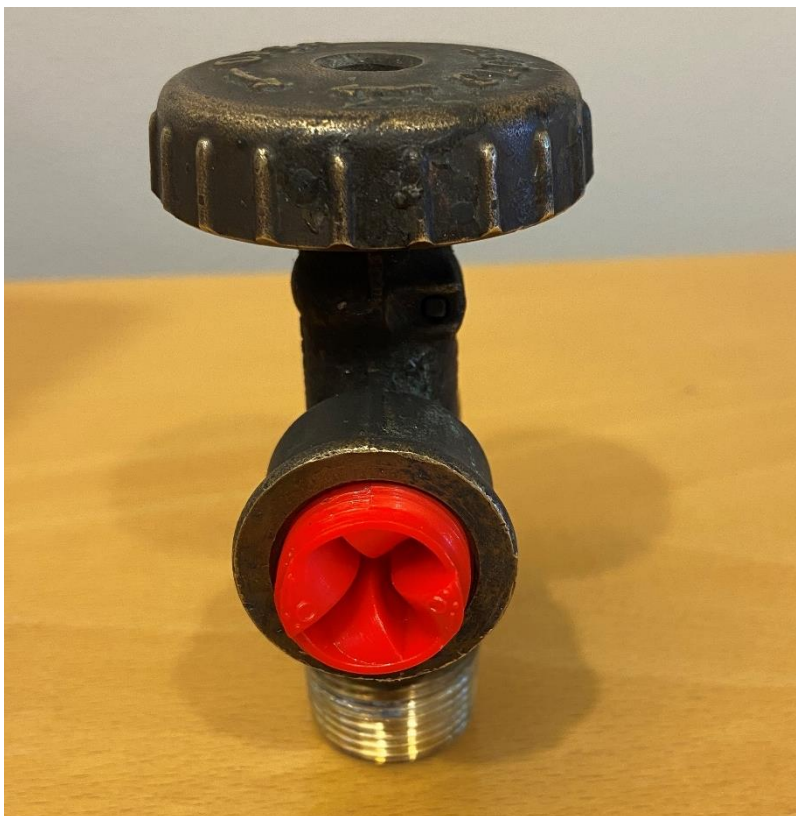
Figur 13. Ventilen från en av gasolflaskorna. En helt ny, röd ventilproppventilpropp av plast är inskruvad i anslutningsgången.
