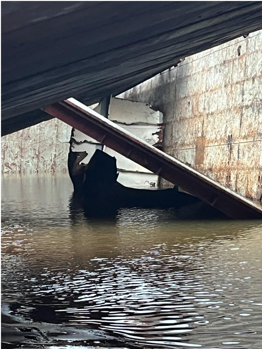
Figur 8. Det förliga lastrumsskottet som hamnat 30 meter akterut i lastrummet under den nedfallna lastrumslucka 4.
