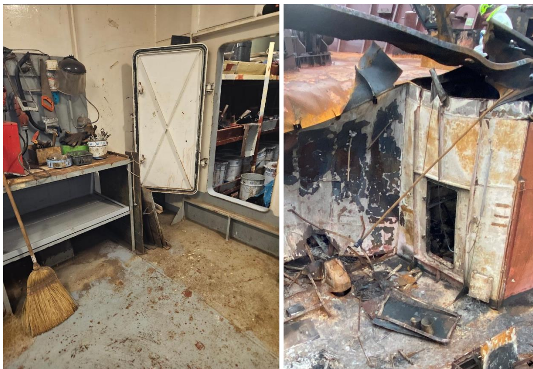
Figur 7. Jämförelsebilder av färgförrådets kortsida före och efter explosionen. Vänster bild: Privat från besättningen. Höger bild: tagen av SHK vid undersökningen.
