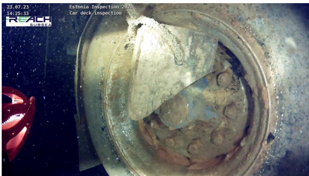
Figur 5.3: Videomaterial från bildäck visar ett laststopp bredvid den förskjutna lastenheten på bildäcket på MV ESTONIA under den visuella inspektionen 2023 (O 2.21).
