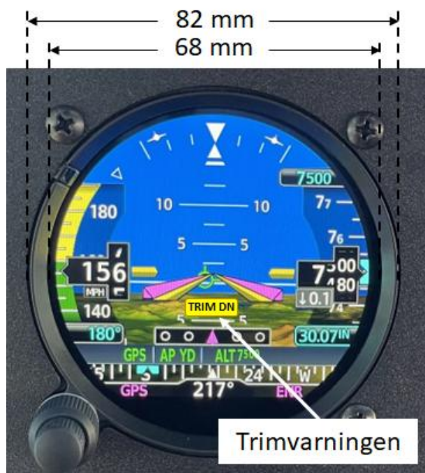
Figur 21. Gul trimvarning i PFD markerat med en vit pil. Bild: Supercub.org. Markeringar och trimvarningen (TRIM DN) införd av SHK.
