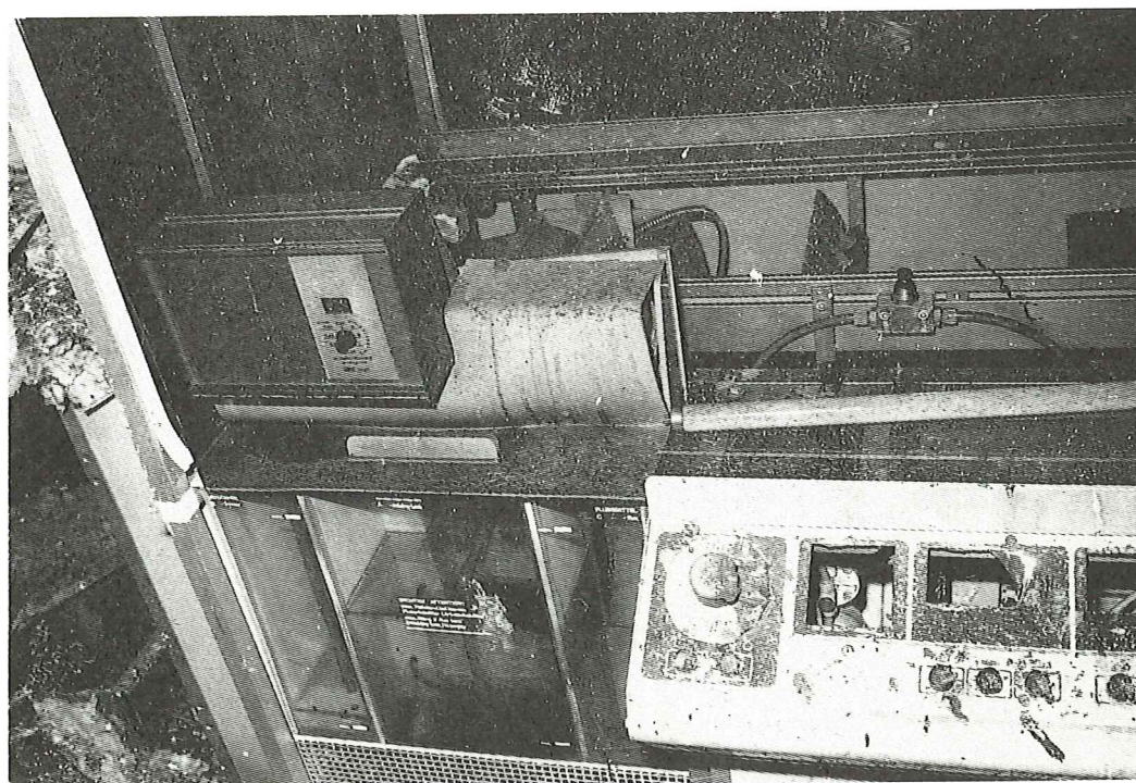
Figur 9 Lödmaskinens manöverpanel. Till vänster syns vätskebehållarna, vilka innehåller isopropanol och flussmedelslösning. Vätskenivån syns på bilden. Till vänster på manöverpanelen syns den knapp som skadats av strålningsvärmern
