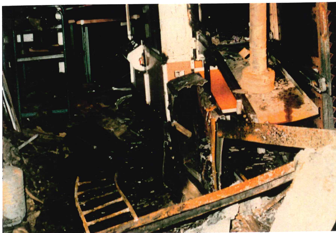
Figur 5 Den värmeskadade lödmaskinen med märkskylt. Kanalen som står på transportbandet är tredje kanalen i föregående figur. Det som syns under märkskylten är en del av plasthuven från tvättmaskinen.
