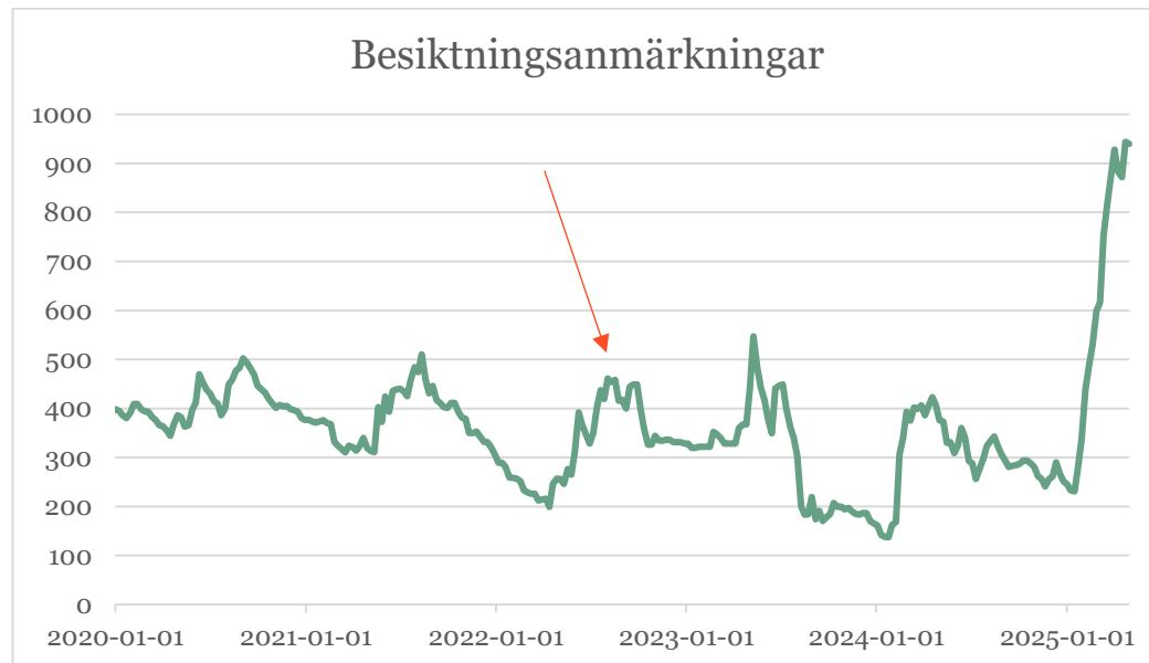
Figur 12. Antalet besiktningsanmärkningar per vecka på bandel 902 (Malmö godsbangård) under perioden 1 januari 2020 till 30 april 2025. Pilen visar när Infranord AB tog över underhållet från Strukton Rail AB.
