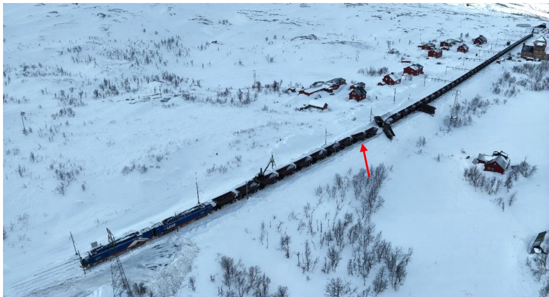
Figuren visar hela tåg 9915 på Vassijaure driftplats med loken till vänster i bild. Den första urspårade, nionde vagnen i tåget, är markerad med en röd pil.
