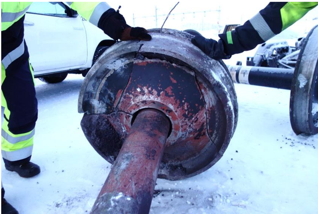
Figuren visar det skadade hjulet med de två lösa delarna inpassade. På vänster sida av hjulet framgår en spricka från löpbanan till navet.
