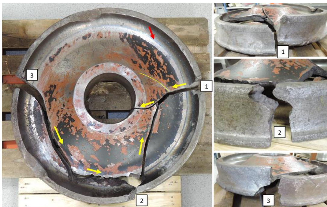
Figuren visar det skadade hjulet med brottytorna markerade 1–3. Den blå färgskiftningen av värmeoxider framgår innanför hjulringen, markerad med en röd pil. De gula pilarna visar brottens riktning enligt den fraktografiska undersökningen.
