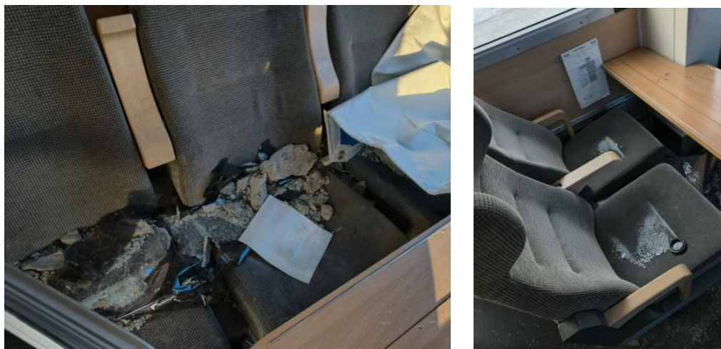
Figur 5. Bilderna visar mindre bitar av betong och glassplitter i kupén. Foto: SJ AB.
