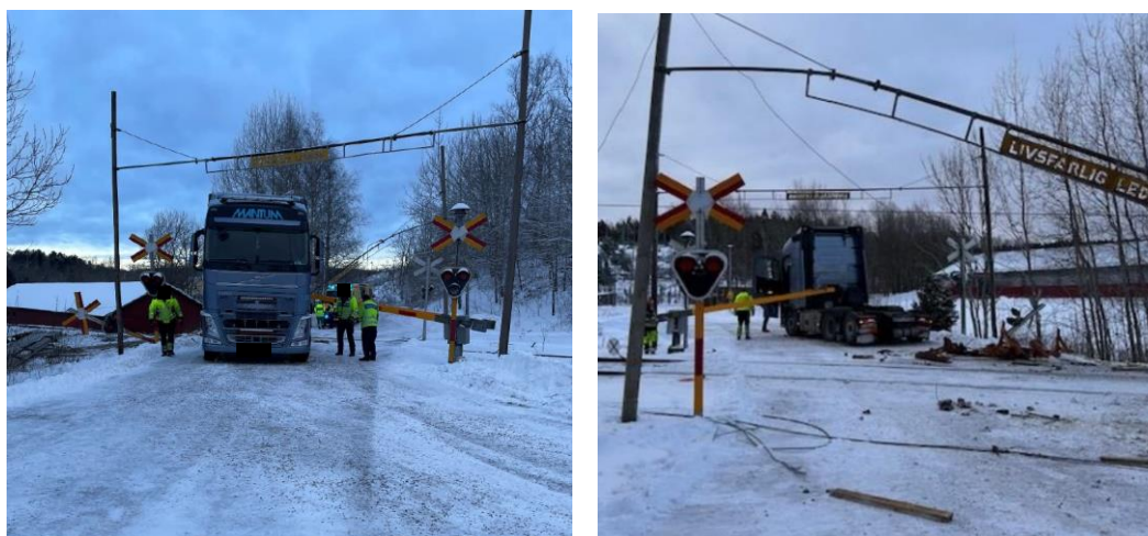
Figur 6. Bilderna visar hur ena bommen fastnade mot lastbilen. Foto: Trafikverket.
