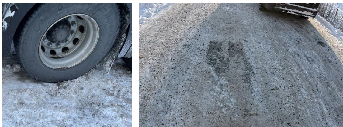
Figur 3. Bilder visar att lastbilen slirade i vägunderlaget. Foto: Bilden till vänster är tagen av Trafikverket. Bilden till höger är tagen av SHK dagen efter olyckan.
