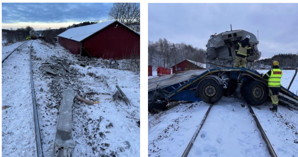
Figur 4. Bild till vänster visar betongelement som låg utspridda efter kollisionen. Skador uppstod på ladan till höger. Bild till höger visar släpvagnen samt förarhytten på tåget som var totalförstörda. Foto: Trafikverket.
