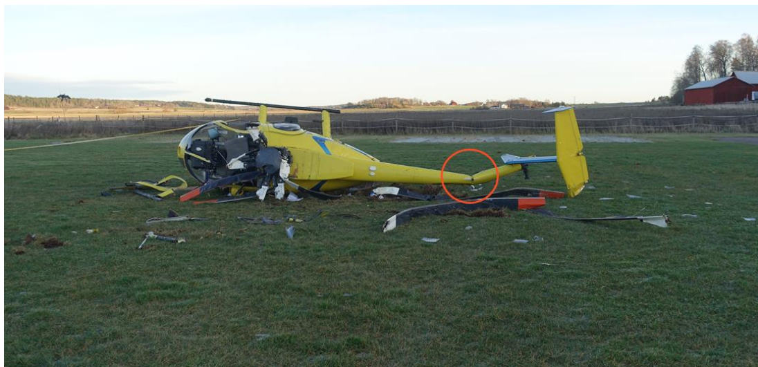
Figur 8. Luftfartygsvraket, skadan på stjärtbommen markerad med en ring.
