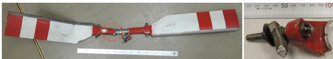
Figur 12. Bilden till vänster visar stjärtrotorn. Markeringen visar området som har varit föremål för undersökning. Bilden till höger visar det avbrutna bladhornet med del av länkarm.
