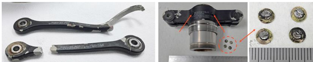
Figur 11. Bilden till vänster visar de skadade länkarmarna. Bilderna till höger visar de skadade nitarna. Nit-skallarna kommer från insidan av kopplingen.
