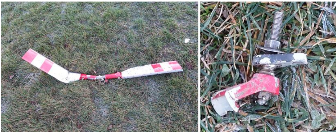
Figur 9. Vänster bild visar stjärtrotorn där den påträffades. Höger bild visar ett av stjärtrotorns bladhorn med del av en länkmarm.
