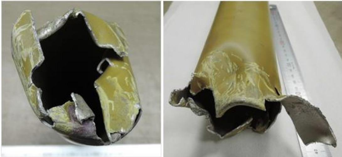
Figur 13. Bilden till vänster visar brottet på den del av drivaxeln som går mot motorn. Bilden till höger visar brottet på drivaxeln som går mot stjärtrotorväxellådan.
