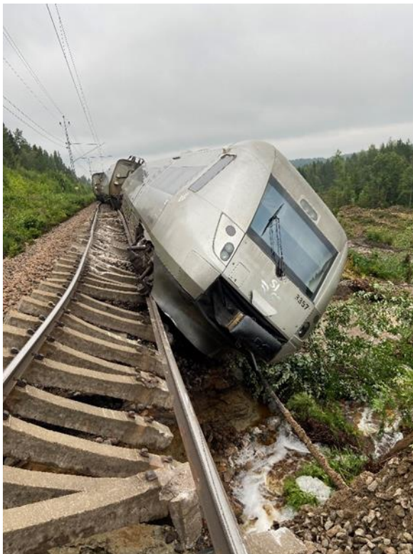
Bilden visar de tre bakersta vagnarna och vattnet som forsar genom den rasade banvallen.
