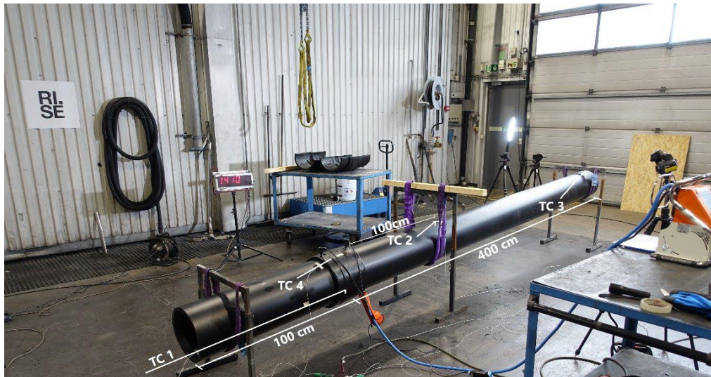
Figur 16. Bild som visar testuppställningen av rör med monterad elmuff. De temperaturgivare som användes för att registrera temperaturerna under testerna är markerade i vitt med beteckningen TC1-TC4. Källa: RISE.
