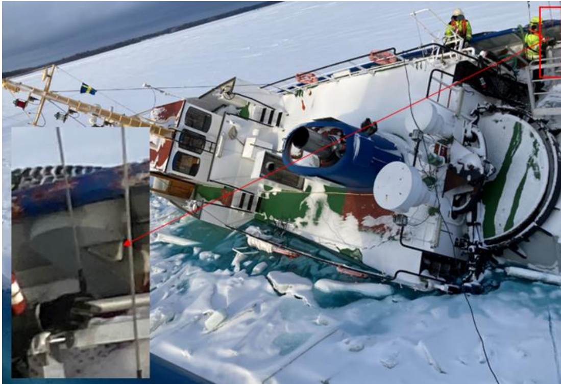
Figur 11. Förstoringen visar en ventilator på styrbord sida där tillslutningsanordningen är öppen. Foto: Kustbevakningen den 14 februari, redigerat av SHK.
