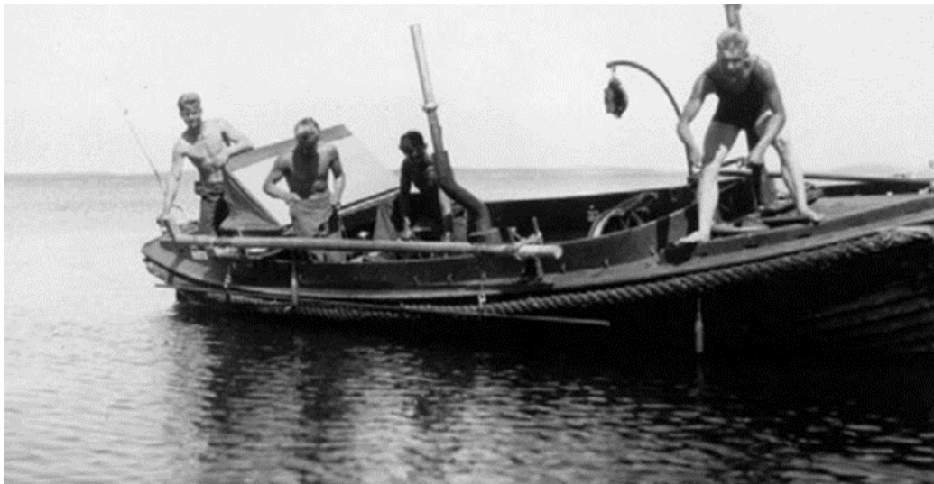
Figur 12. Äldre mätmetod för att inhämta djupdata med hjälp av handlodning. Foto Sjöfartsverket.
