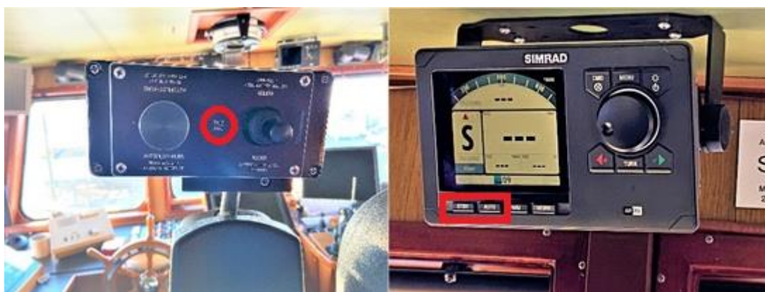
Figur 5. Vänstra bilden: Kontrollen för automatstyrningen på vänster armstöd (armstödet uppfällt). Mellan vridknappen och spaken syns den lysdiod som indikerar driftläge (markerad med en röd cirkel). Högra bilden: Automatstyrningens huvudenhet som fanns i takhöjd. Längs ner till vänster ses de två knapparna STBY och AUTO som indikerar driftläge (markerade med en röd rektangel).
