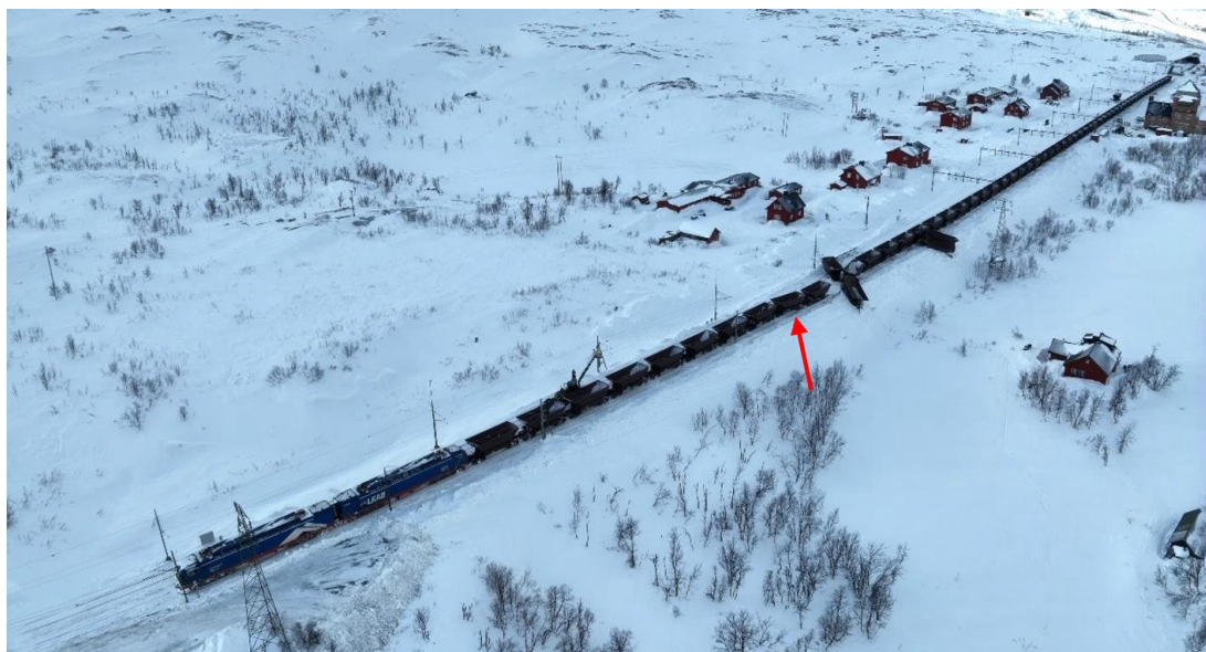
Figur 2 visar hela tåg 9915 på Vassijaure driftplats med loket till vänster i bild. Den första urspårade, nionde vagnen i tåget, är markerad med en röd pil.
