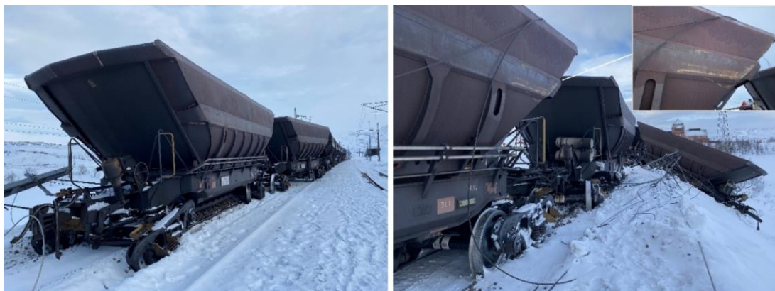
Figur 12 visar till vänster vagn tio och nio framåt i tågets färdriktning. Till höger visas vänster sida av vagn nio, med skrapmärken och vidare vagn tio samt vagn 14 nere i slätten.
