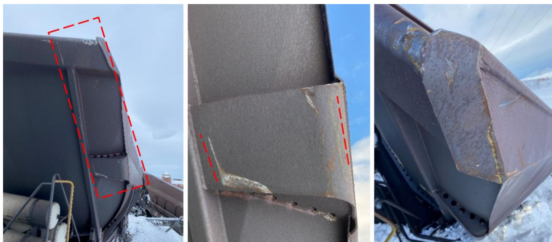
Figur 13 visar i de två vänstra bilderna islagsmärken uppe till vänster på vagn tio. De röda streckade linjerna visar märken från något som motsvarar en kontaktledningsstolpe. Den högra bilden visar skador på vagn elva med färgflagor i grönt och orange.
