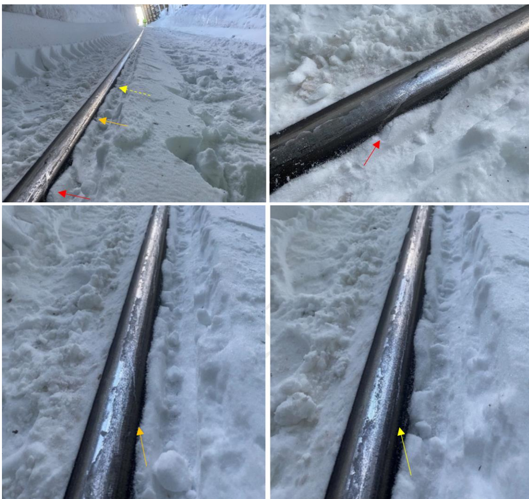
Figur 21 visar fyra bilder i tågets färdriktning med märken från flänsar som klättrat över den vänstra rälen. På översiktsbilden finns färgade pilar och respektive märke med pil visas enskilt.
