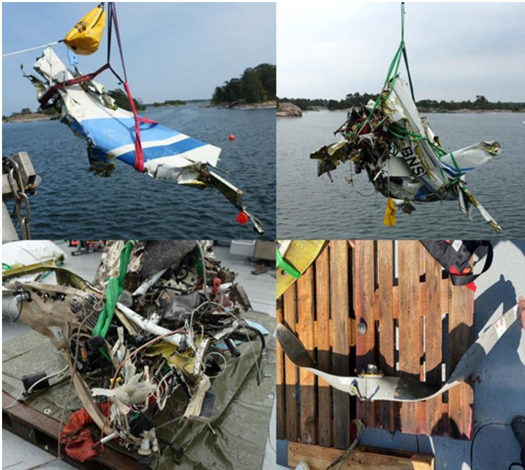
Figur 18. Bilderna visar höger vinge, flygplanskroppen med vänster vinge, motor samt instrumentbräda och propeller.
