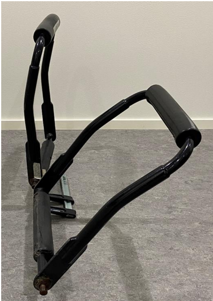
Figur 21. Säkerhetsbygel från vagn 5 vänster, här ställd bakom en oskadad bygel. Bygel från vagn 5 böjdes ca 30 grader framåt, till nästan helt öppet läge vid olyckan.
