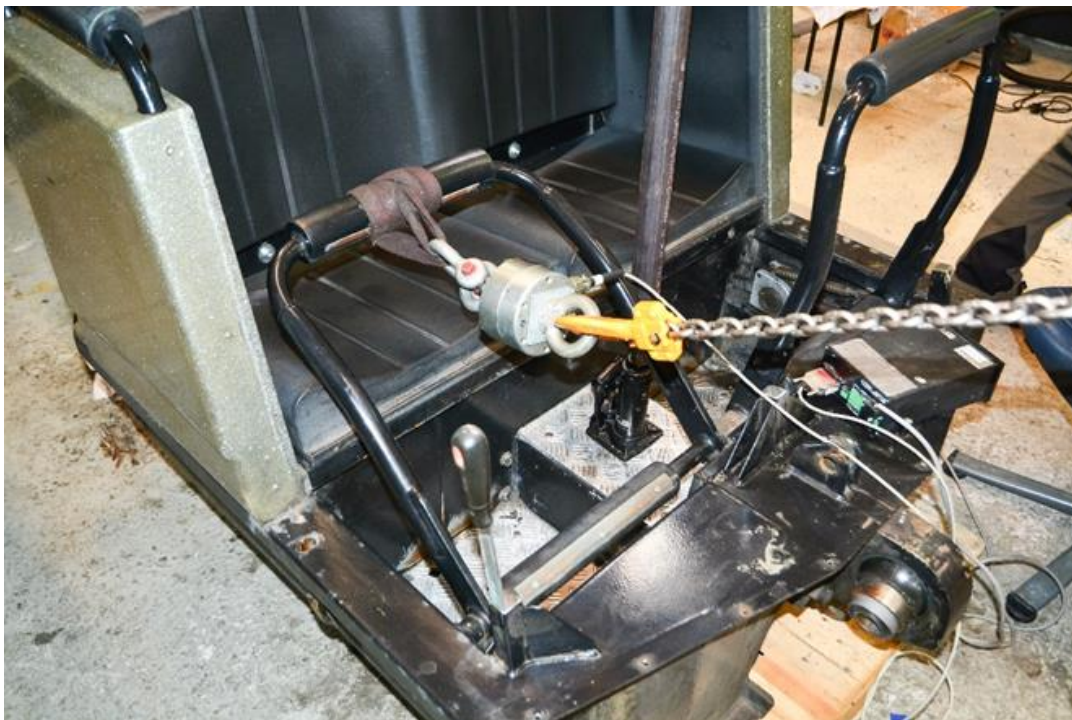
Figur 22. Riggning vid dragprov av en säkerhetsbygel.
