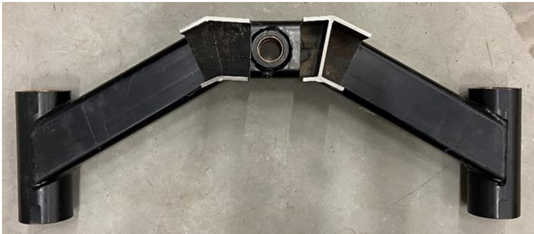
Figur 19. Bilden visar en bärmarm med utsågade prover lagda ovanpå. Provet till vänster är från en bärmarm tillverkad 2019 och till höger från en ursprunglig bärmarm. Den tvärställda plåten som saknas i den vänstra syns i den högra delen.
