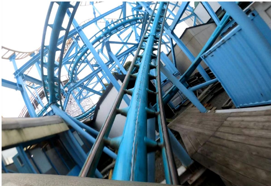
Figur 23. Bild från testkörningen som visar tåget i positionen för första islaget i banan. Hastigheten var vid detta tillfälle 88 km/h och belastningen var 4,7 g i främre vagnen.
