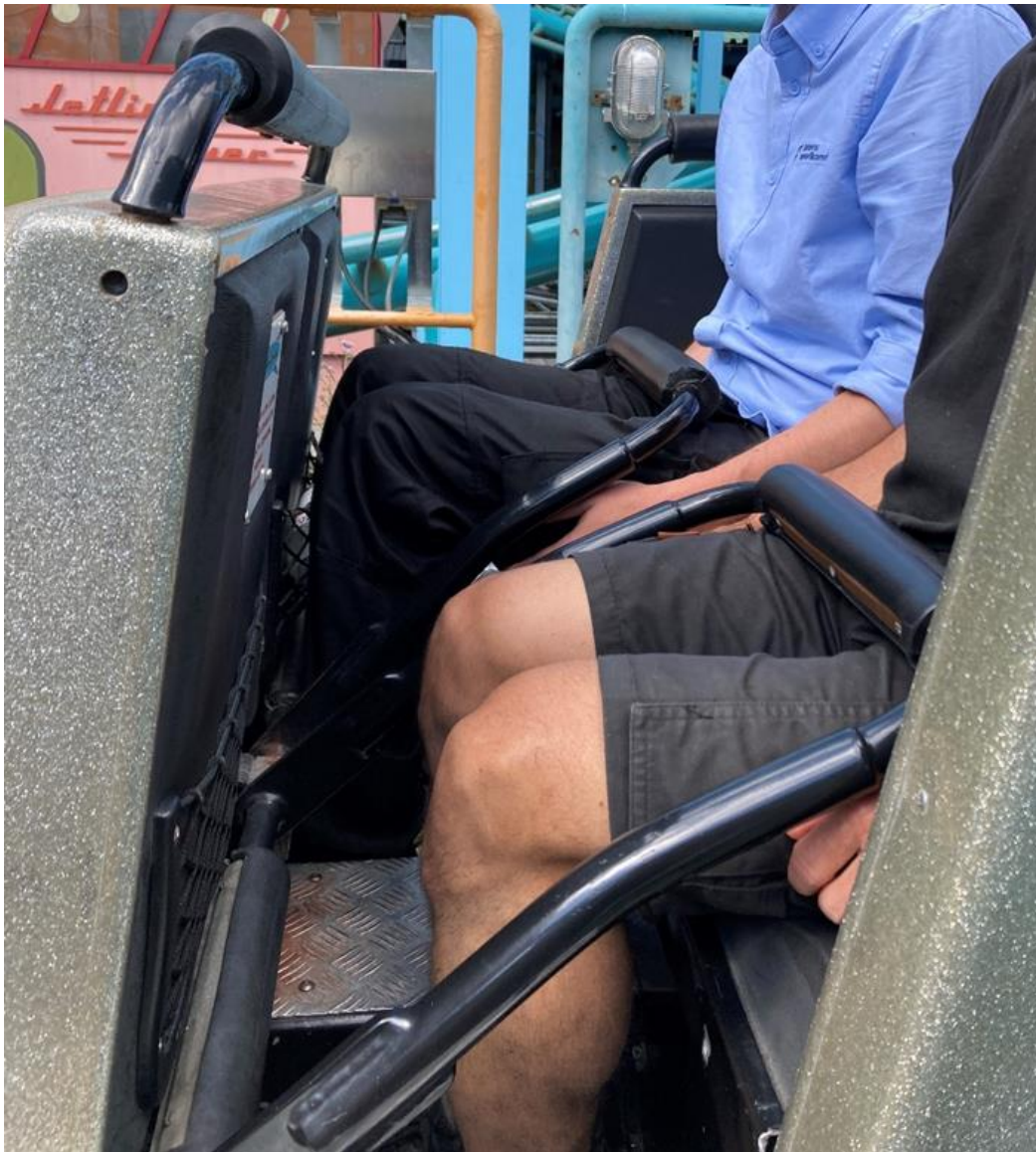
Figur 9. Säkerhetsbyglarna i vagnarna som fälldes ner mot mage/lår.
