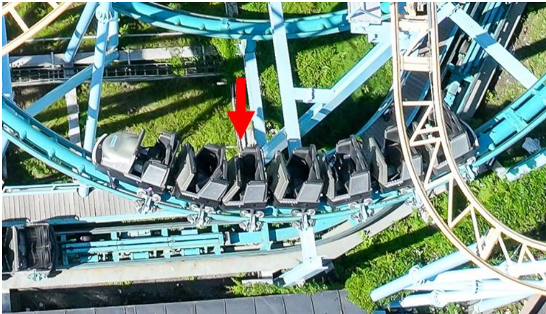
Figur 14. Bild på tåget efter olyckan. Notera hur fronten i vagn tre har vikt sig bakåt (markerad med pil).
