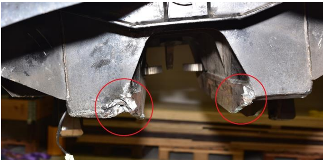
Figur 13. Skador i den främre vagnens undre del. Röda markeringar visar var islagen skett.
