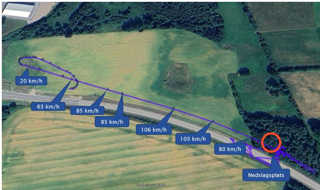
Figur 5. Registrerade data från en av navigeringsapplikationerna med hastigheten över marken. Markeringar infogade av SHK. Bild: Google Earth.
