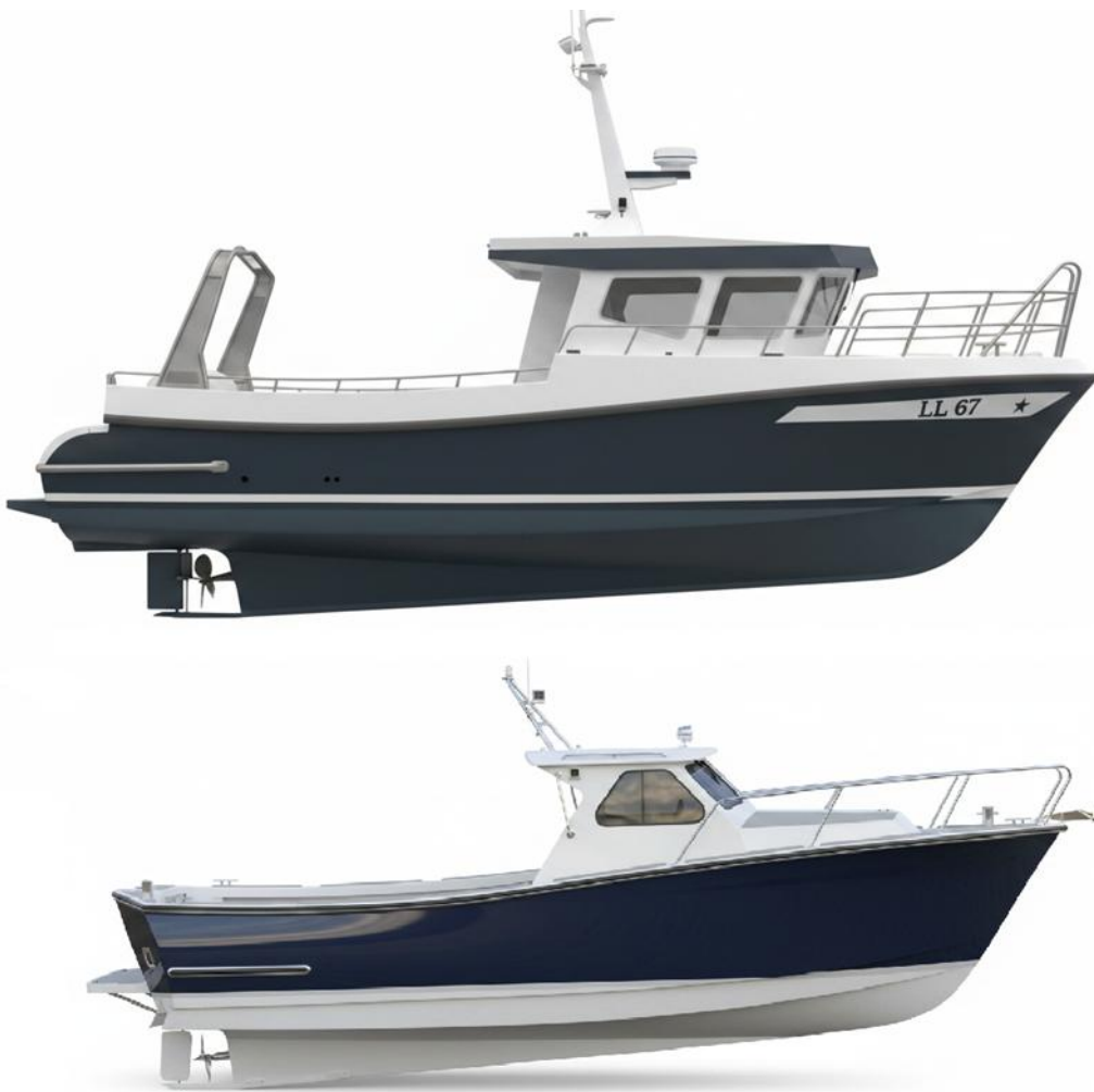
Figur 4. Den övre illustrationen visar HAJEN med dess modifierade överbyggnad och badbrygga i aktern. Den undre illustrationen visar hur båtmodellen (Lochin 33/Nordsjö 33) såg ut i originalutförande. Illustrationerna är framställda av SHK med hjälp av AI-verktyg. Den undre illustrationen är baserad på en ritning från tillverkaren.
