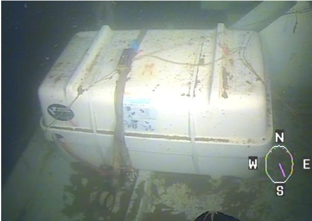
Figur 10. Livflotten och den hydrostatiska frigöraren. Till höger om surrningsbandet ses en dekal med instruktioner om hur den hydrostatiska frigöraren ska monteras. Bild från Kustbevakningen
