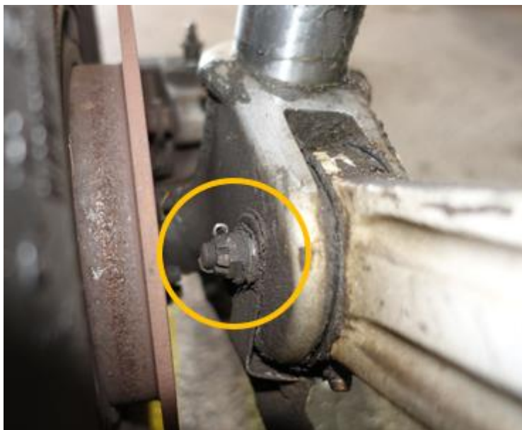
Figur 8. Motsvarande skruvförband på vänster huvudlandställ. Saxpinne och kronmutter markerade med gul ring.
