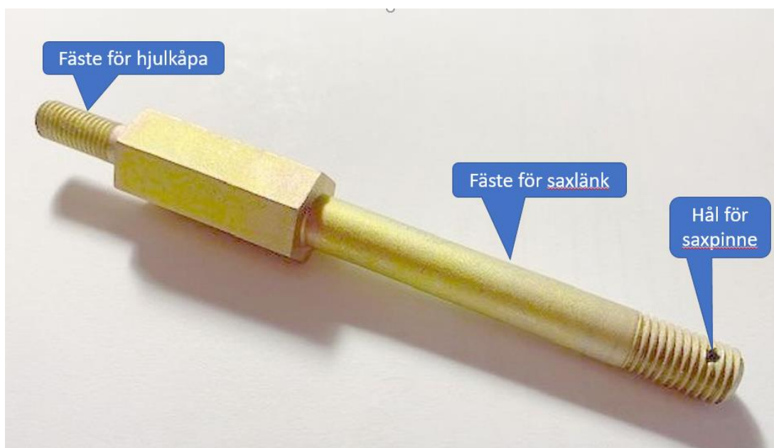
Figur 6. Skruv, partnummer 37881-003, med hål för saxpinne.
