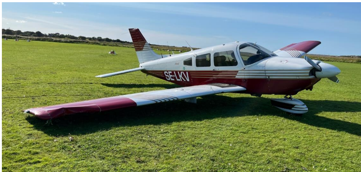
Figur 1. Flygplanet med synliga skador på höger vinge. Foto: Privat.
