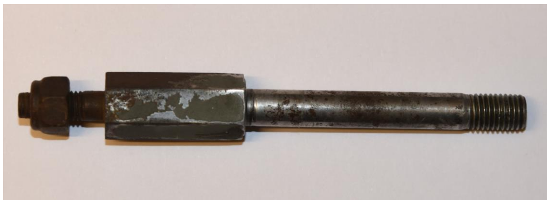
Figur 7. Den undersökta skruven. Den grövre delen är för nedre infästning av saxlänken. Den tunnare delen med mutter monterad på är fäste för hjulkåpa. Skruven saknar hål för saxpinne.
