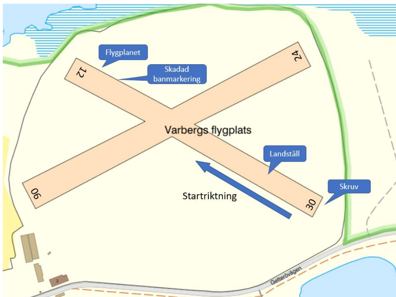
Figur 3. Flygplatsområdet med ungefärliga positioner för skruven till saxlänken, den separerade nedre delen av landstället, skadad banmarkering och flygplanets slutliga position. Markeringar infogade av SHK.
