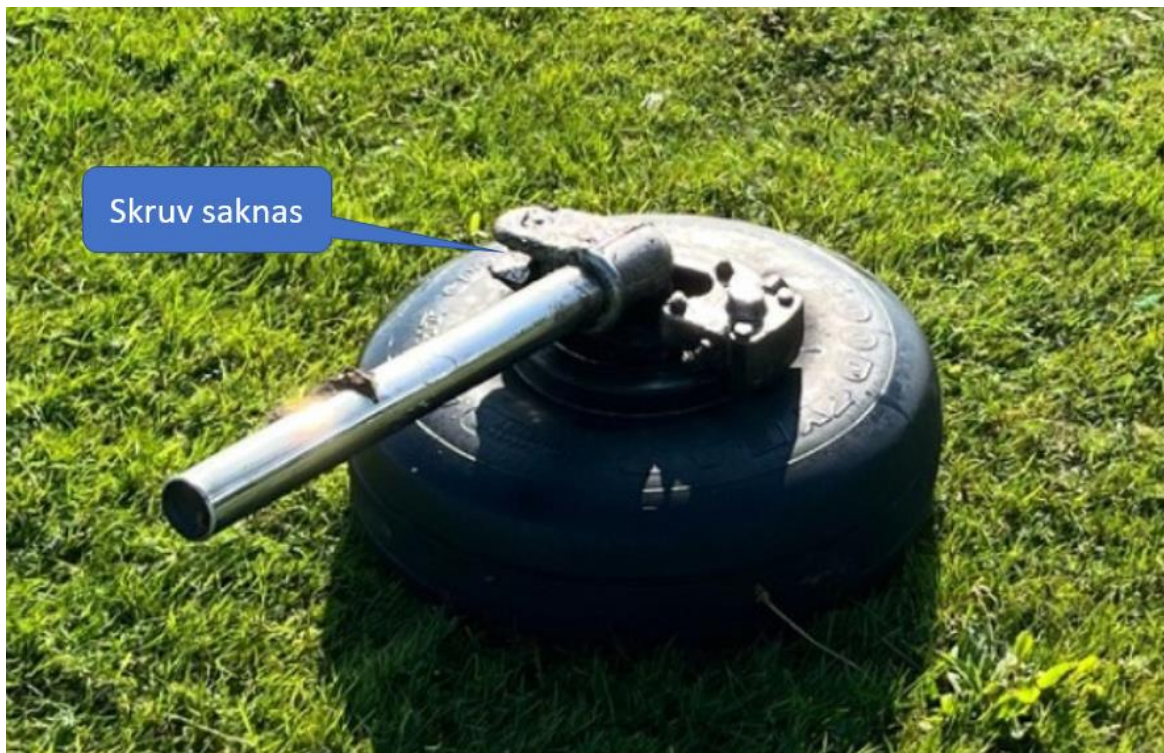
Figur 2. Nedre delen av höger landställ separerat från flygplanet. Skruv för infästning av saxlänken saknas. Textruta infogad av SHK. Foto: Privat.
