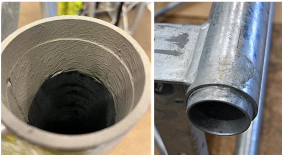
Figur 8. Bilden till vänster visar insidan av ett maströr och den grova kontaktytan som skapar friktion. I bilden till höger syns stosen som styr in röret så att rören centreras vid hopmontering.
