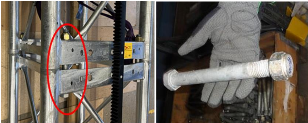
Figur 7. Bilden till vänster visar två mastsektioner som är ihopsatta med ett skruvförband i varje hörn. Skruven är monterad med muttern överst, se markering. Bilden till höger visar ett skruvförband bestående av en skruv och mutter. Skruvlängden är 250 mm.
