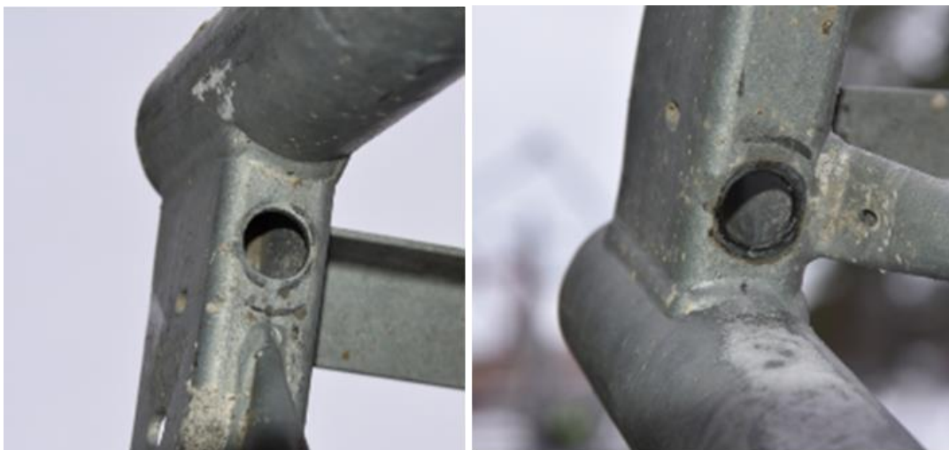
Figur 17. Bilderna visar två av skruvhålen i mastsektion 19. Vid skruvhålen syns inte några belastningsskador som tyder på att skruvar varit monterade vid olyckan.
