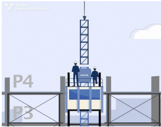
Figur 13. Bilden visar en animering av två montörer som tar emot en sammansatt mastdel med tre mastsektioner. Utklipp från en animering som SHK har tagit fram.
