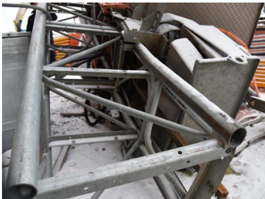
Figur 16. Rörstrukturen i mastsektion 21. På bilden syns en tydlig deformation av rörstrukturen.
