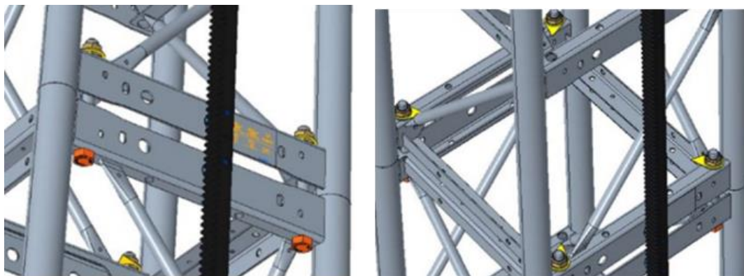
Figur 24. Tillverkarens vidtagna åtgärder efter olyckan. Färgade skruvhuvuden och plastindikatorer för muttrar. Bild: Alimak Group Sweden AB.
