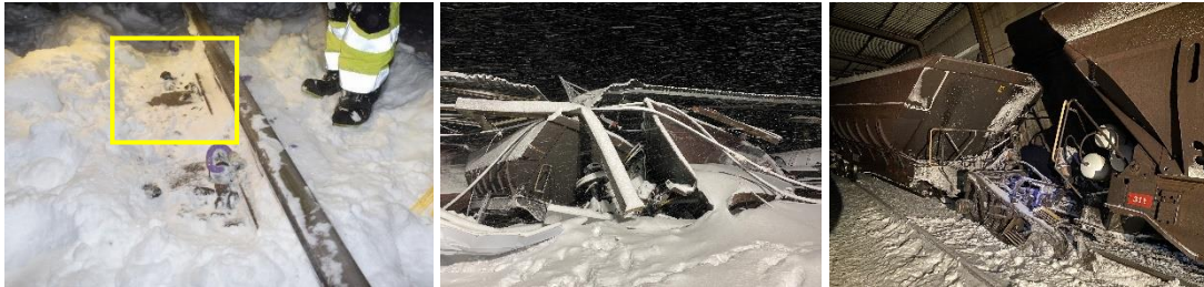
Bilderna visar den första skadan i rälets befästning på järnvägens längdmätning km 1520 samt urspårade vagnar på Vassijaure driftplats vid km 1535.
