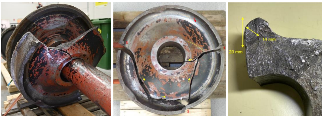
Bilderna visar det skadade hjulet före demontering, hjulet i samband med undersökningar samt sprickan i flänsen vid den primära brottytan.
